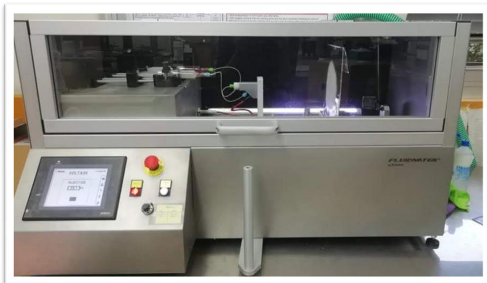
Εικόνα 6: Συσκευή Ομοαξονικής Ηλεκτροστατικής Ινοποίησης - FLUIDNATEK LE-10, Biolnicia
