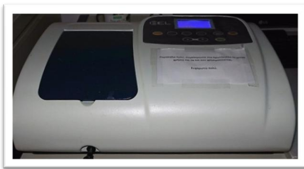
Εικόνα 5: Φωτομέτρηση των δειγμάτων στα 765 nm
