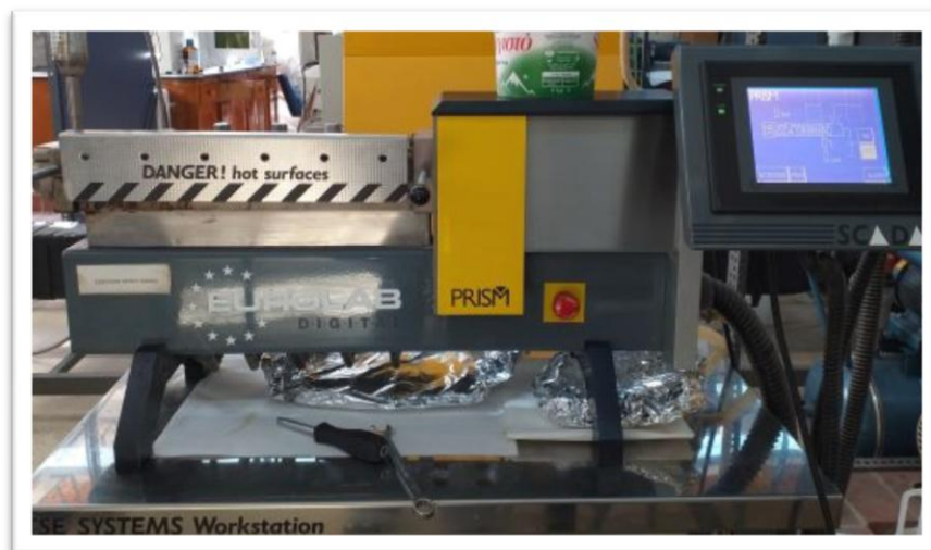
Εικόνα 13: Συσκευή εκβολής - extruder
