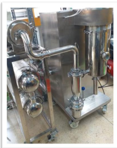
Εικόνα 12: Συσκευή ξήρανσης με εκνέφωση (spray drying)
