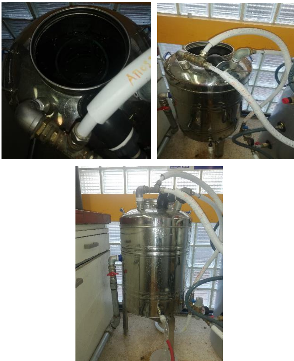
Σχήμα 13: Εναλλάκτης θερμότητας για την συμπύκνωση της αιθανόλης.
