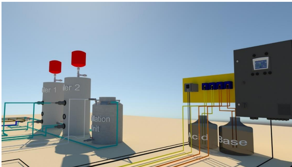
Σχήμα 8: Απεικόνιση βιοαντιδραστήρα, καθώς και σωληνώσεις και καλωδιώσεις από διαφορετική οπτική γωνία.
