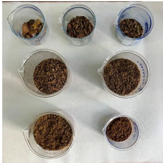
Σχήμα 25: Κόκκοι από κάθε κόσκινο, αρχίζοντας από το πρώτο αριστερά το μεγαλύτερο (10mm).
