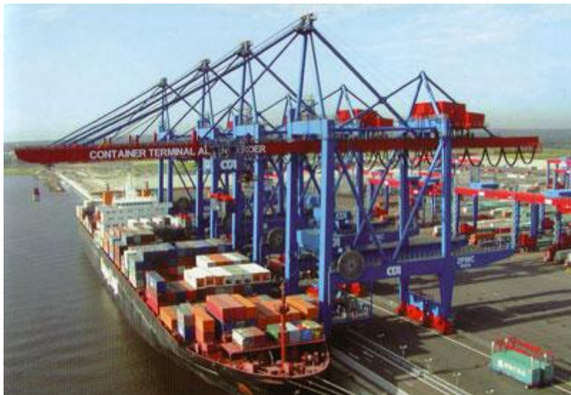
Σχήμα 4.2: ZPMC: Ένα από τα μοντέλα γερανογεφυρών προβλήτας που λειτουργούν στον σταθμό εμπορευματοκιβωτίων “Χ”
