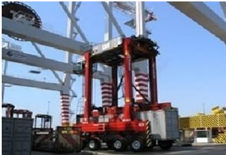
Σχήμα 6.12: Υβριδικό ανυψωτικό μηχανήμα στοιβασίας και μεταφοράς εμπορευματοκιβωτίων τερματικού σταθμού
