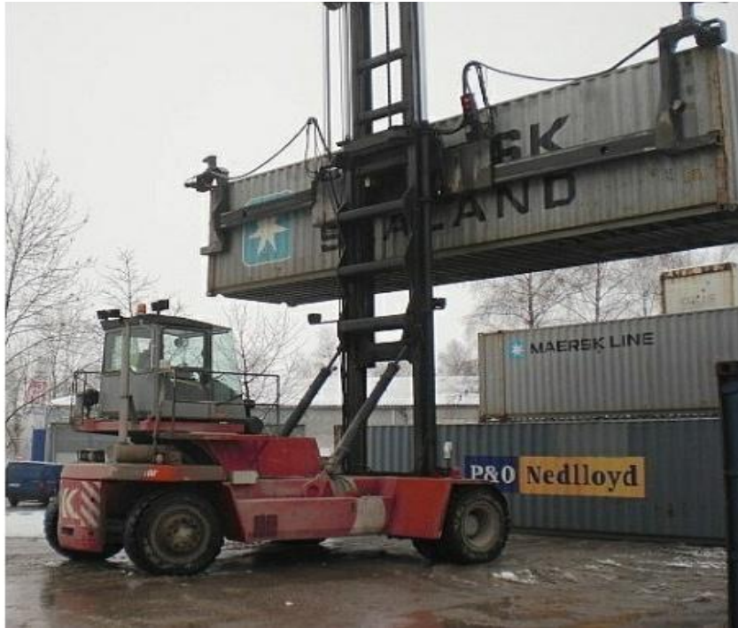
Σχήμα 4.4: Kallmar DCE 90-45: Μηχάνημα χειρισμού κενών εμπορευματοκιβωτίων
