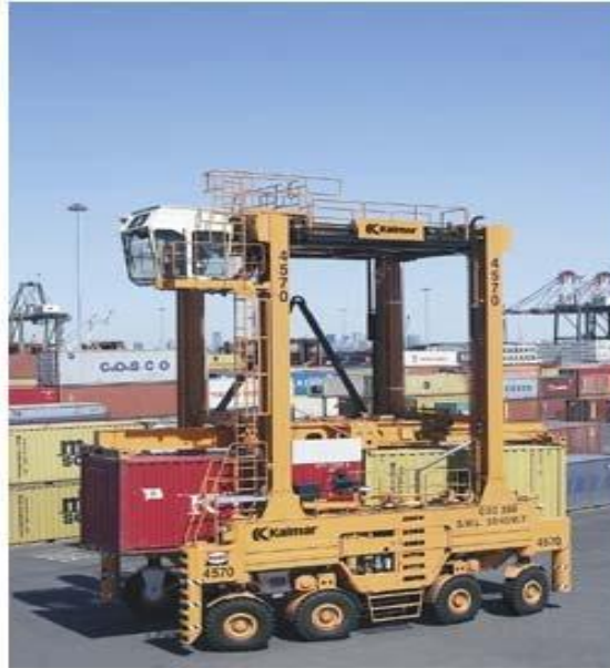
Σχήμα 4.3: Kallmar CSC 350: Ανυψωτικό μηχάνημα στοιβασίας και μεταφοράς εμπορευματοκιβωτίων
