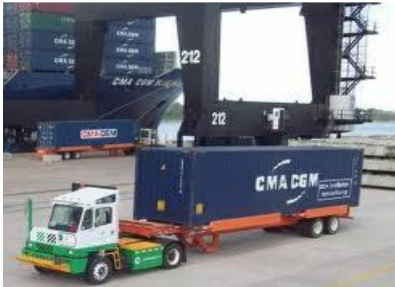
Σχήμα 6.11: Υβριδικός τράκτορας τερματικού σταθμού εμπορευματοκιβωτίων
