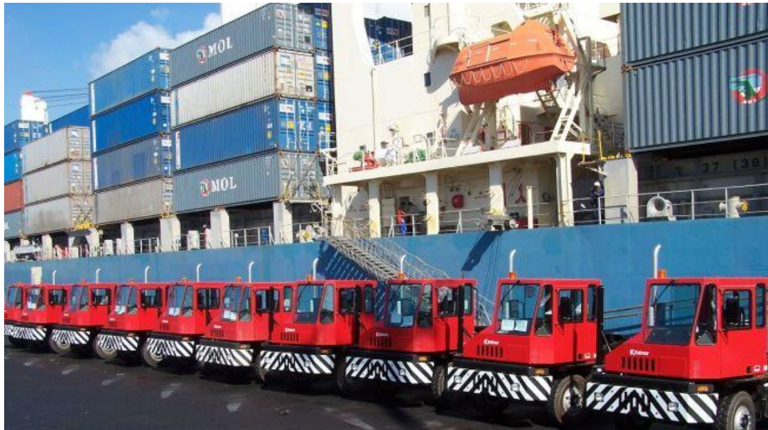
Σχήμα 4.5: Kalmar Tr 618i: Τράκτορες τερματικού σταθμού “X”
