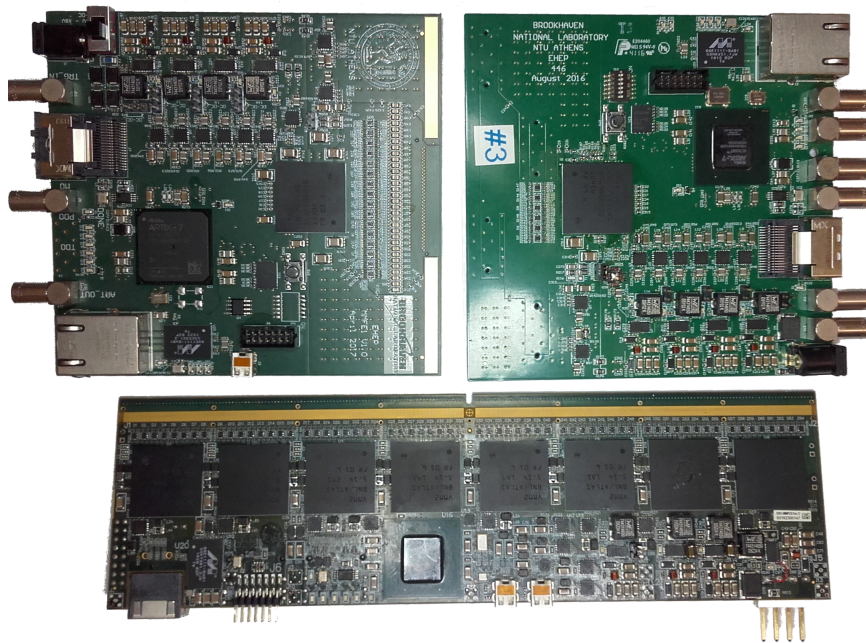
Figure I.15: Τρεις πλακέτες που φιλοξενούν VMM, και το FPGA για το οποίο έχει σχεδιαστεί το υλικολογισμικό που θα περιγραφεί σε αυτό το Κεφάλαιο. Πάνω δεξιά είναι η MDT_446, πάνω αριστερά η MMFE1, και κάτω η MMFE8. Στις πλακέτες διακρίνεται το FPGA, το VMM και οι κοννέκτορες της διεπαφής Ethernet.
