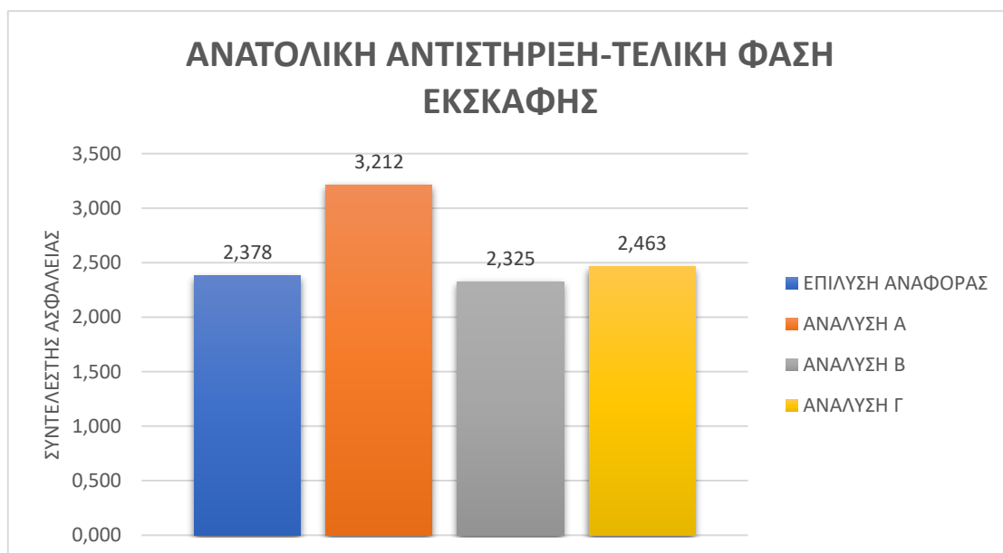
Ιστόγραμμα 6. 3: Διάγραμμα αξιολόγησης του συντελεστή ασφαλείας στην τελική φάση της εκσκαφής των διαφόρων αναλύσεων, του ανατολικού συστήματος αντιστήριξης.
