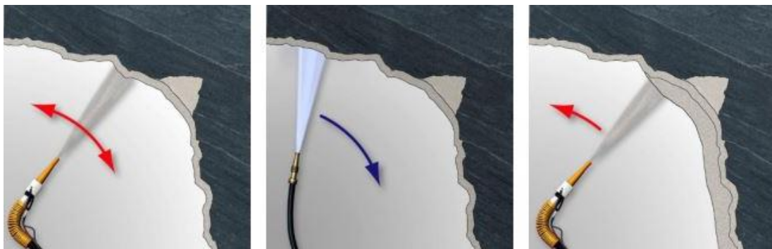
Σχήμα 3. 14: Διαδικασία ψεκασμού εκτοξευμένου σκυροδέματος (SIKA HELLAS ABEE).
