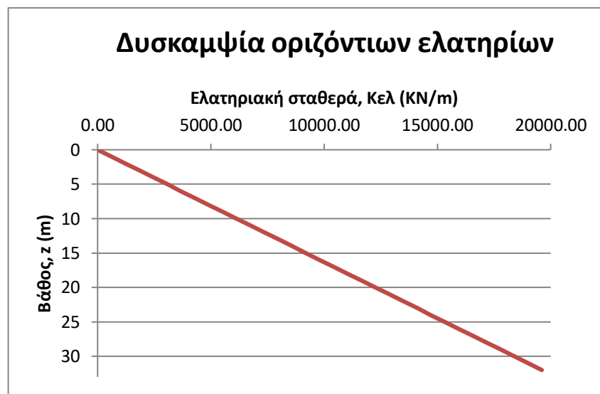
Σχήμα 2-9: Διάγραμμα δυσκαμψίας οριζόντιων ελατηρίων των πασσάλων
