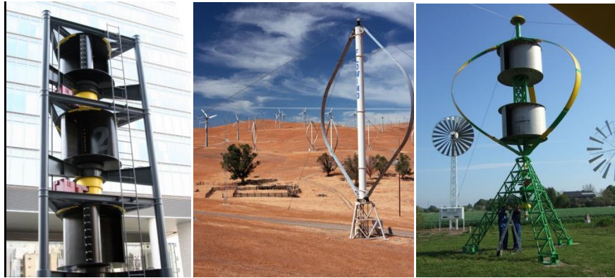
Σχήμα 1-9: α) Savonius, β) Darrieus, γ) Συνδυασμός Savonius και Darrieus [6]
