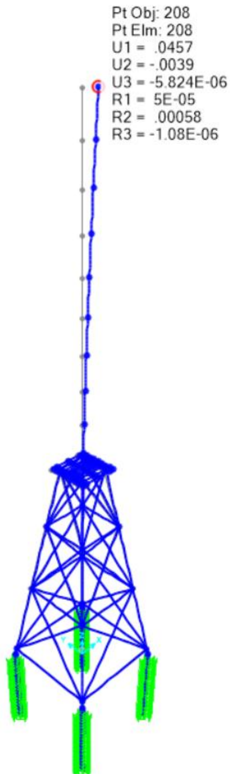
Σχήμα 4-2: 2 η Ιδιομορφή στη διεύθυνση X ( T_x=6.01007\text{sec} )
