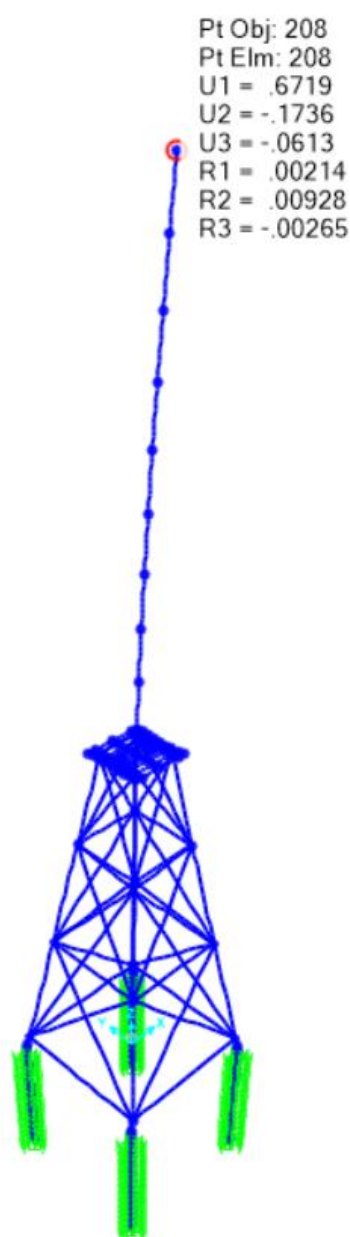
Σχήμα 4-47: Μέγιστη μετακίνηση στην κορυφή του πύργου από 1.0G+0.3Q+1.0EX-0.3EY
