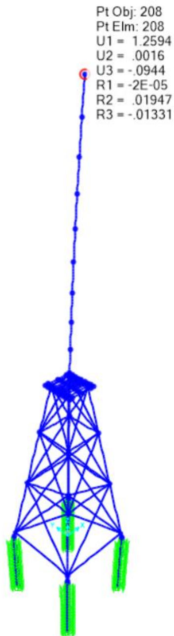
Σχήμα 4-44: Μέγιστη μετακίνηση στην κορυφή του πύργου από 1.35G+1.5Q+0.9W_X+0.9WAV_X-nonlinear
