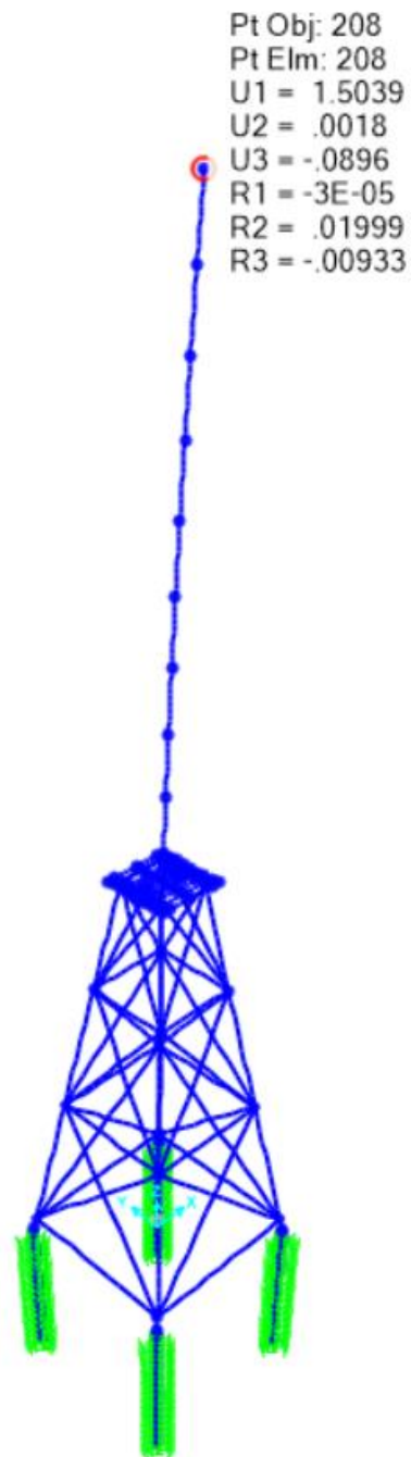
Σχήμα 4-45: Μέγιστη μετακίνηση στην κορυφή του πύργου από 1.35G+1.05Q+1.5W_X+0.9WAV_X – nonlinear
