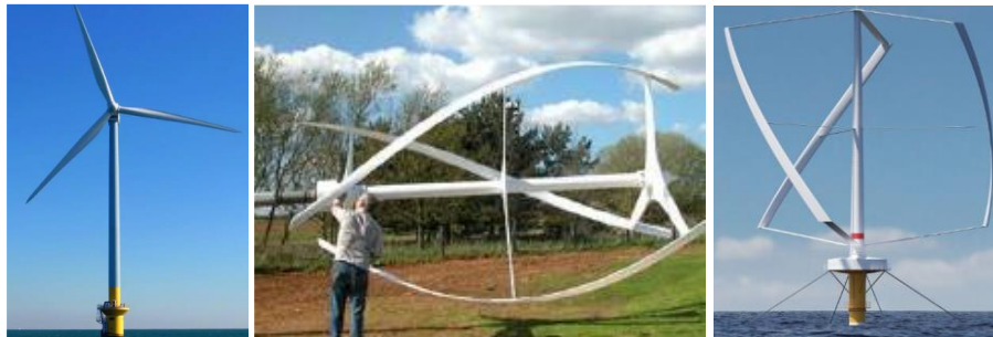
Σχήμα 1-7: Τύποι ανεμογεννητριών α)οριζόντιου άξονα με περιστροφή παράλληλη στον άνεμο, β)οριζόντιου άξονα με περιστροφή κάθετη στον άνεμο, γ)κατακόρυφου άξονα [3]
