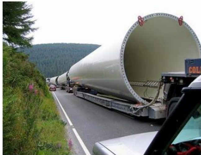
Σχήμα 1-13: Μεταφορά προκατασκευασμένων τμημάτων μέσω οδικού δικτύου [5]
