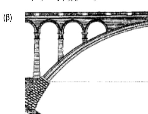
Σχήμα 10. (α) Ενδεικτική λεπτομέρεια σύνδεσης τοιχείων άνωθεν τόξου και (β) τοξοστοιχίες άνωθεν τόξου, κατά τον Γάλλο μηχανικό Paul Séjourné.
