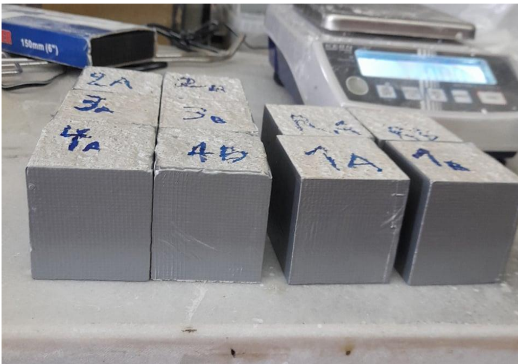
Εικόνα 23. Κυβικά δοκίμια τσιμέντου καλυμμένα περιμετρικά με μονωτική ταινία.
