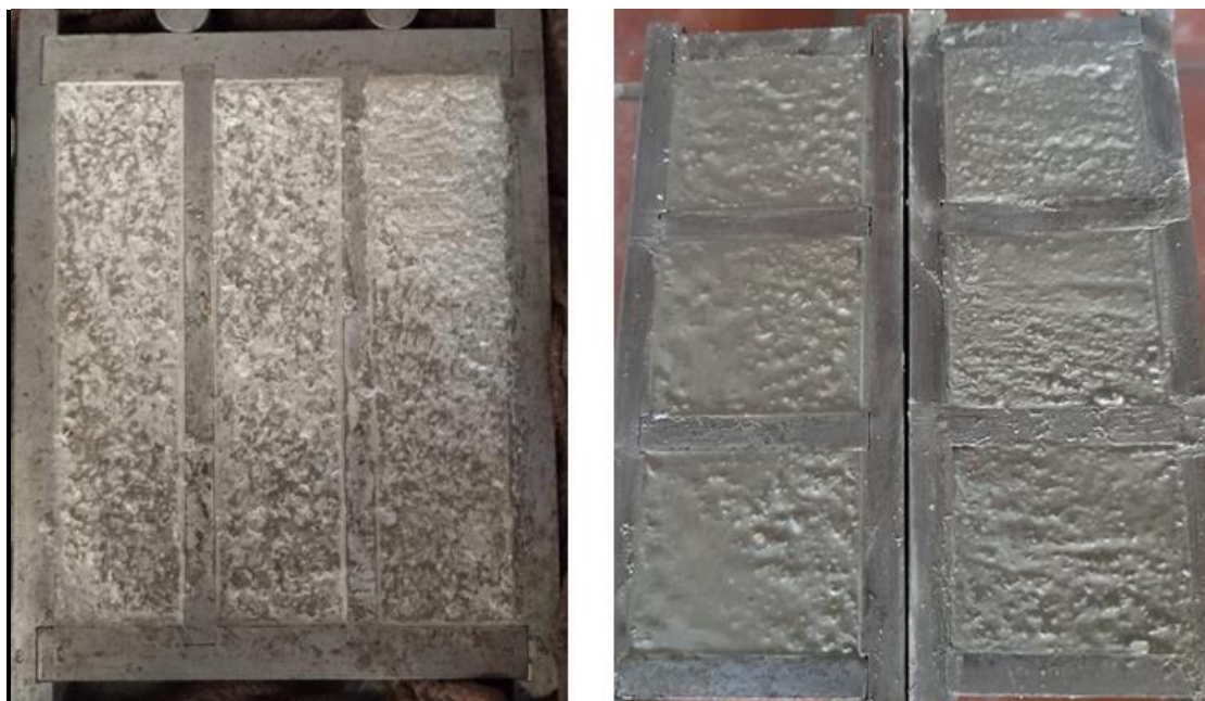
Εικόνα 18. Δοκίμια τσιμέντου τοποθετημένα σε ασφάλινα πρισματικά και κυβικά καλούπια.
