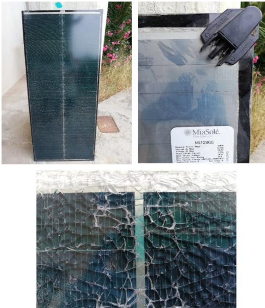
Εικόνα 14. Φωτοβολταϊκή μονάδα (panel) λεπτού υμενίου CIGS της εταιρείας MiaSolé.
