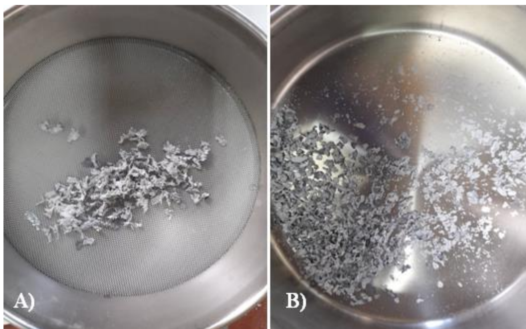
Εικόνα 25. Α) Παρατηρούμενη μορφή του δείγματος MIASOL, η οποία συλλέχθηκε σε κόσκινο διαμέτρου 4 mm. Β) Παρατηρούμενη μορφή του δείγματος MIASOL, η οποία συλλέχθηκε σε κόσκινο διαμέτρου 2,5 mm.
