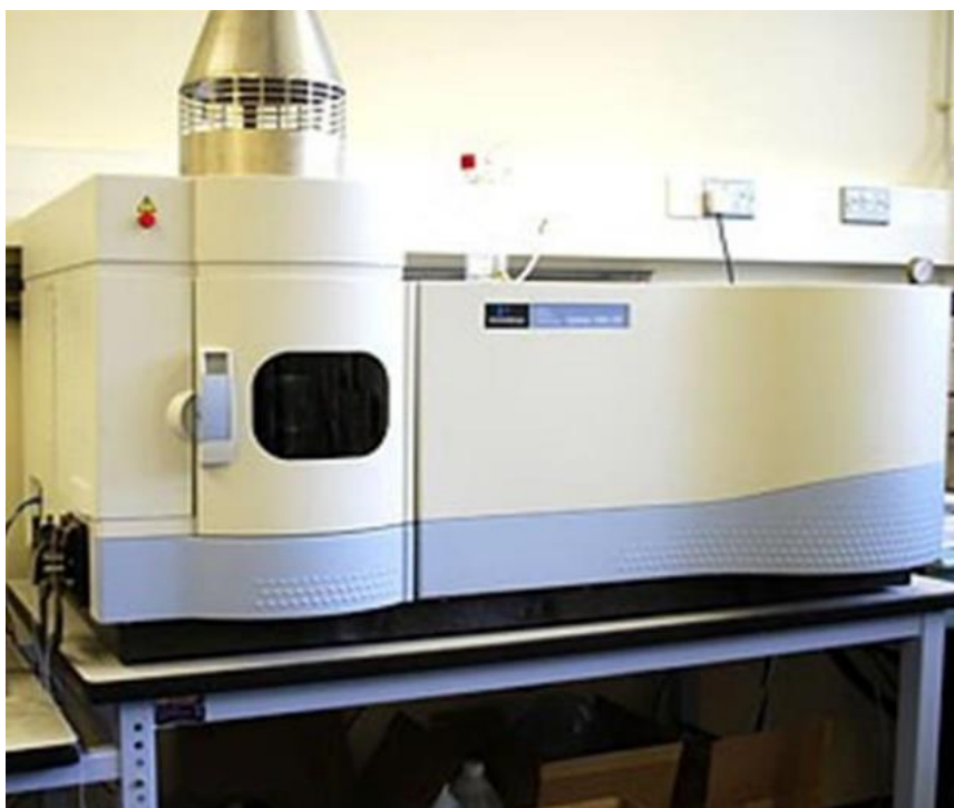
Εικόνα 12. Διάταξη οργάνου της φασματομετρίας οπτικής εκπομπής με επαγωγικά συζευγμένο πλάσμα (ICP - OES), στο οριζόντιο εργαστήριο της Σχολής Χημικών Μηχανικών.
