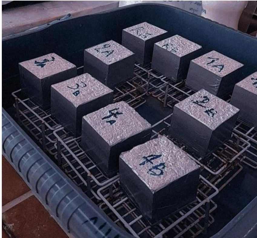
Εικόνα 24. Κυβικά δοκίμια τσιμέντου εντός λεκάνης με νερό.
