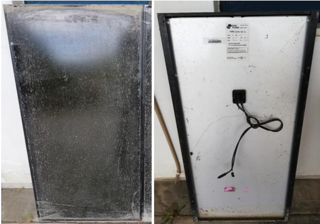
Εικόνα 15. Φωτοβολταϊκή μονάδα (panel) λεπτού υμενίου CIS της εταιρείας SolarFrontier, από το οποίο προήλθαν τα θραύσματα φωτοβολταϊκών κυττάρων που χρησιμοποιήθηκαν στις εκχυλίσεις μετά από μηχανική κατεργασία.
