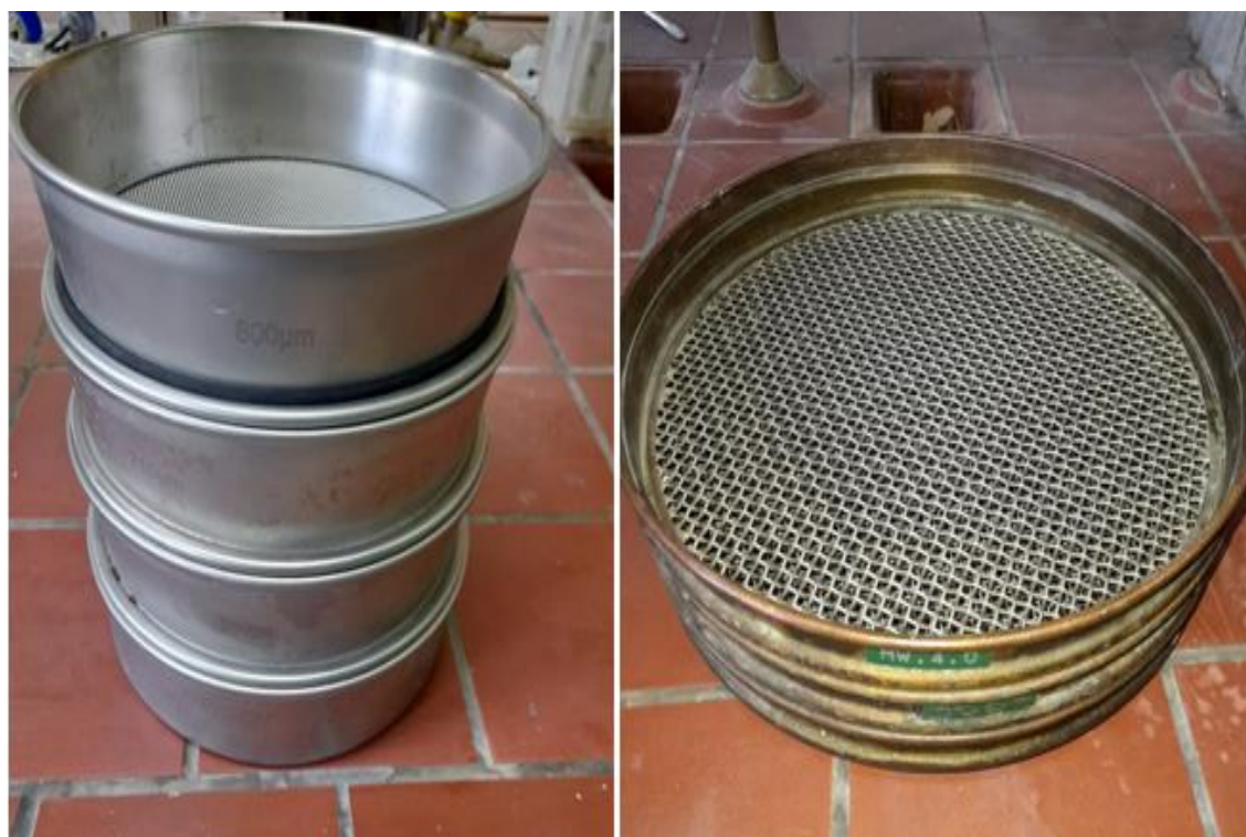
Εικόνα 16. Διάταξη κοσκίνισματος του δείγματος, με χρήση κοσκίνων διαφόρων διατομών.
