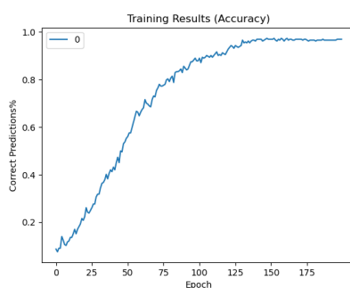
Σχήμα 8.31: Ακρίβεια δικτύου που δημιουργήθηκε με "τυχαία λειτουργία e-prop"
