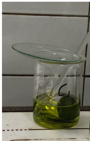
Εικόνα 5.9. Διαλυτοποίηση δείγματος σύντηξης.
