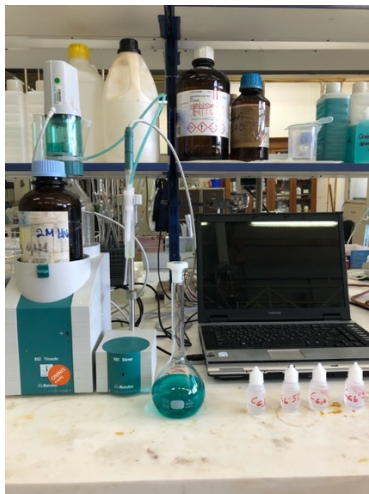
Εικόνα 5.7. Αραίωση με χρήση συσκευής Τιτρίνο.
