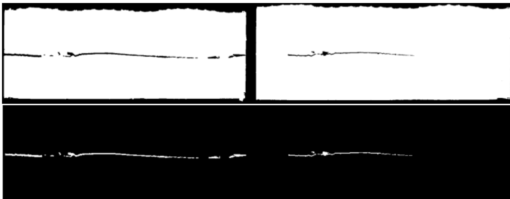
Σχήμα 19: Εικόνες της διατομής μετά από τη μορφολογική επεξεργασία despeckle (a,b), και το VOI revert (c,d) για τα δείγματα των 0 και 48h.
