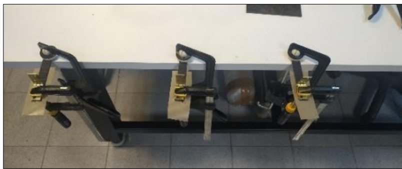
Εικόνα 34: Τοποθέτηση μεντεσέδων στις άκρες των δοκιμίων.
