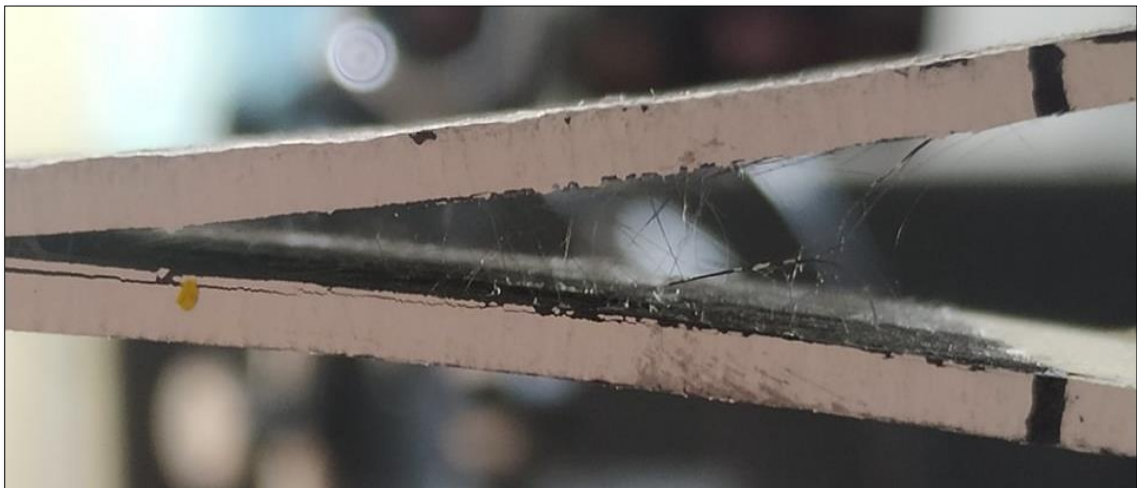
Εικόνα 37: Το φαινόμενο της γεφύρωσης των ινών (Fiber bridging) το οποίο δημιουργείται κατά την διάρκεια της δοκιμής (DCB test).
