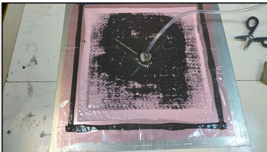
Εικόνα 32: Τα σύνθετα panel κατασκευάζονται μέσω της τεχνικής vacuum bagging.
