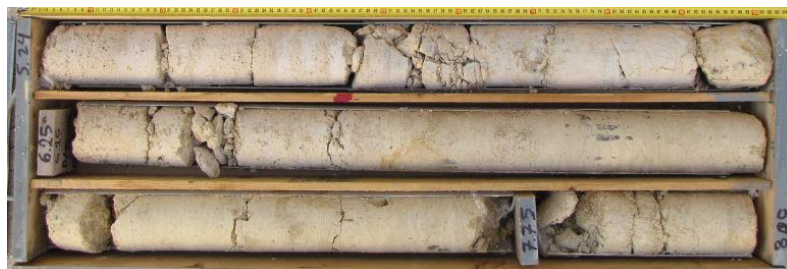
Εικόνα 4-6: Απεικόνιση του σχηματισμού του ασβεστιτικού ψαμμίτη-ψαμμίτη, από τον πυρήνα της γεώτρησης BQBP0063
