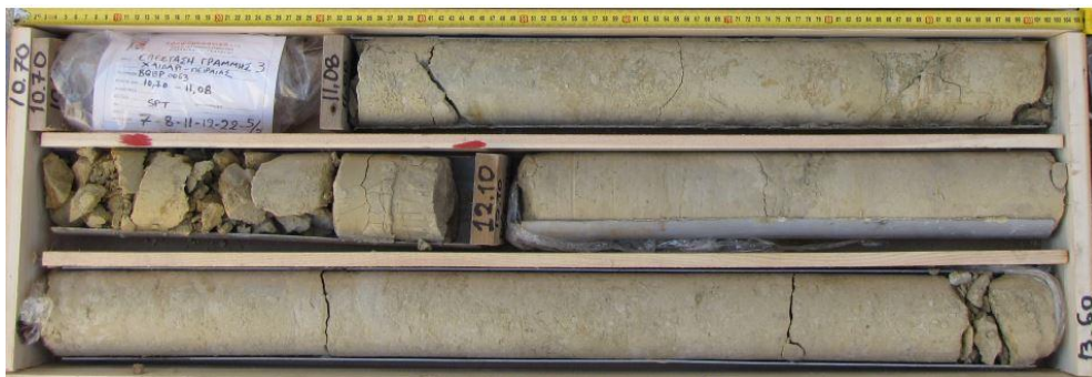
Εικόνα 5-3: Ασβεστιτικός Ιλυόλιθος, άρρηκτος με κατάσταση ασυνεχειών καλή, GSI=80 (Φωτογραφία από τη γεώτρηση BQBP0063 από το βάθος 10.7m έως 13.6m)
