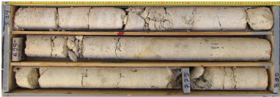
Εικόνα 5-2: Ασβεστίτικος Ψαμμίτης με αδιατάρακτη δομή κατά θέσεις και κατάσταση ασυνεχειών καλή, GSI=80 (Φωτογραφία από τη γεώτρηση BQBP0063 από το βάθος 5.25m έως 8m)
