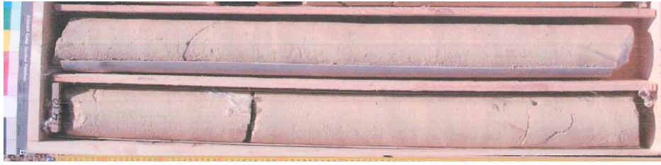
Εικόνα 5-1: Ασβεστίτικος Ψαμμίτης άρρηκτος με λίγες ασυνέχειες σε μεγάλη απόσταση και με κατάσταση ασυνεχειών καλή, GSI=85 (Φωτογραφία από τη γεώτρηση BP2506 από το βάθος 13m έως 15m)
