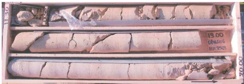
Εικόνα 5-6: Άρρηκτος μαργαϊκός ασβεστόλιθος με μικρή διαταραχή τοπικά και καλή κατάσταση ασυνεχειών, GSI=75
