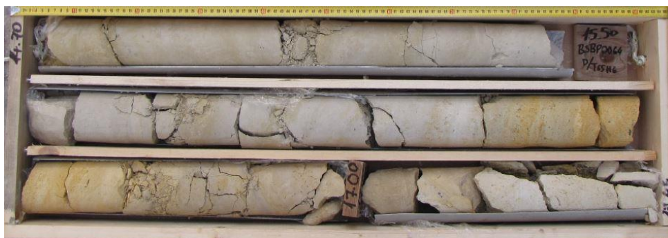
Εικόνα 5-4: Ασβεστιτικός Ιλυόλιθος αδιατάρακτη με κυβικά τεμάχη κατά θέσεις και καλή κατάσταση ασυνεχειών (Φωτογραφία από τη γεώτρηση BSBP0064 από το βάθος 14.7m έως 17.45m)
