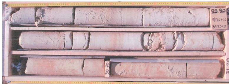
Εικόνα 4-8: Απεικόνιση του σχηματισμού του μαργαϊκού ασβεστόλιθου, από τον πυρήνα της γεώτρησης BP2510
