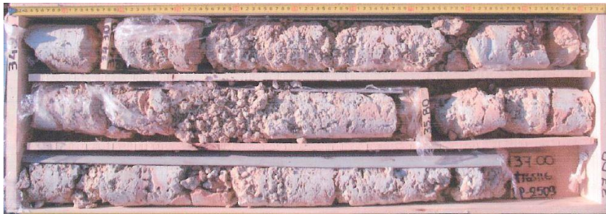
Εικόνα 5-5: Στρώση έντονα αποσαθρωμένου λόγω διάλυσης μαργαϊκού ασβεστόλιθου με χαλαρή δομή, GSI=40 (Φωτογραφία από τη γεώτρηση BP2509 από το βάθος 34.2m έως 37m)
