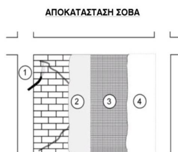
Σχήμα 4.10: Διαδικασία αποκατάστασης των ρωγμών
