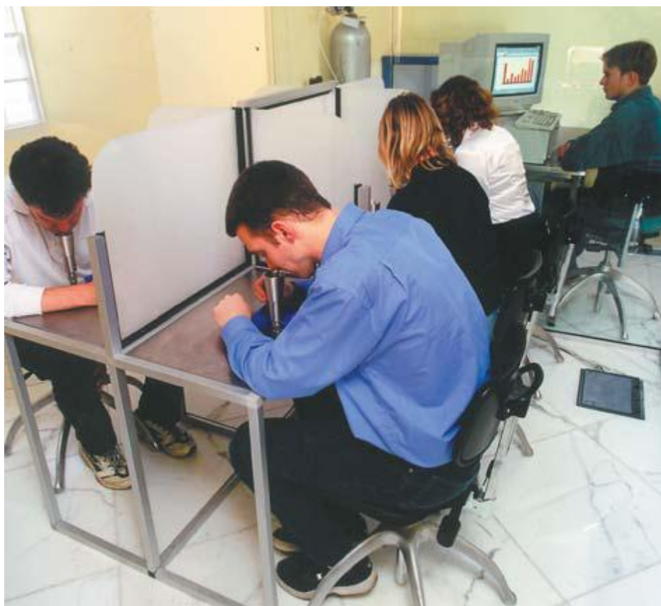
Εικόνα 2 Δυναμική ολφακτομετρία από εξειδικευμένη ομάδα για τη μέτρηση συγκεντρώσεων οσμών, σύμφωνα με το πρότυπο EN13725
