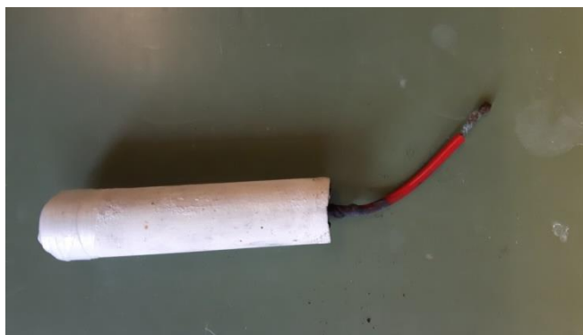
Εικόνα 13: Επικάλυψη με πινέλο (Brush coat) / Επικάλυψη με έκπλυση (Wash coat) – κεραμικά ηλεκτρόδια καθόδου
