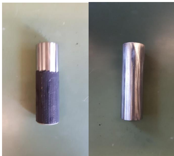
Εικόνα 9: Ηλεκτρόδιο ανόδου με βάση σωλήνα ανοξειδωτου χάλυβα και επίστρωση γραφίτη
