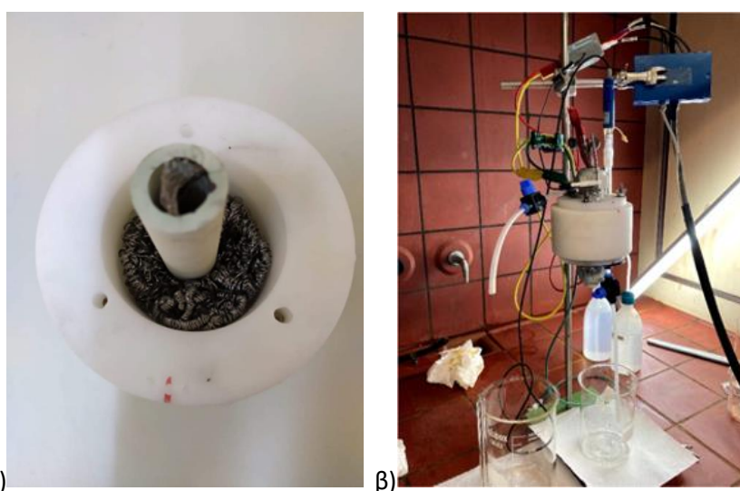
Εικόνα 20: α) Αντιδραστήρας προσομοίωσης MKK (Μικρό MFC), β) Συνολική διάταξη τελικών μετρήσεων
