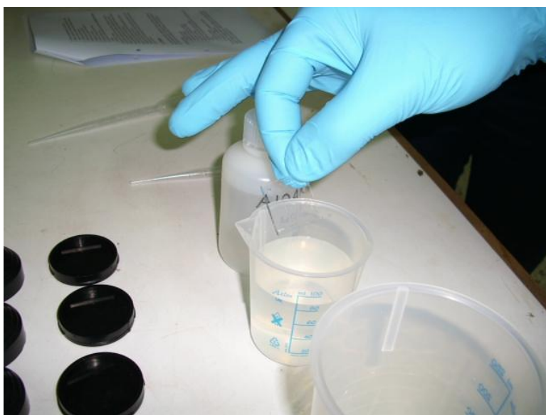
Σχήμα 4.4α: Καθαρισμός των ανιχνευτών με οινόπνευμα, απιονισμένο νερό
