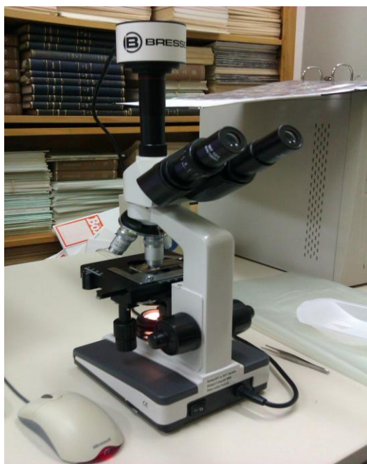
Σχήμα 4.16: Φωτισμός και οριζόντια κλίμακα vernier του μικροσκοπίου τύπου μετάδοσης Bresser Researcher Trino
