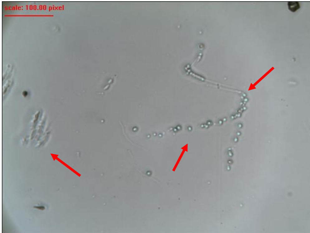
Σχήμα 4.14: Ίχνη που έχουν προκύψει από φθορές και βλάβες της επιφάνειας του ανιχνευτή
