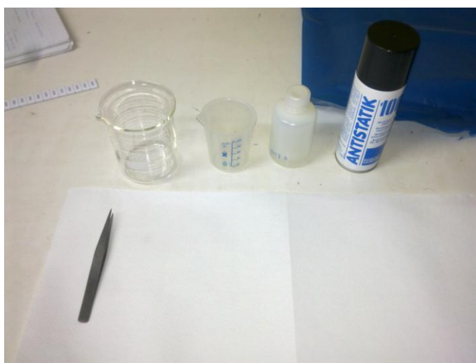
Σχήμα 4.4β: Καθαρισμός των ανιχνευτών με αντιστατικό σπρέι.
