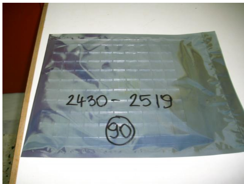
Σχήμα 4.2: Φύλλο 90 αριθμημένων ανιχνευτών CR-39 μέσα σε μεταλλική σακούλα
