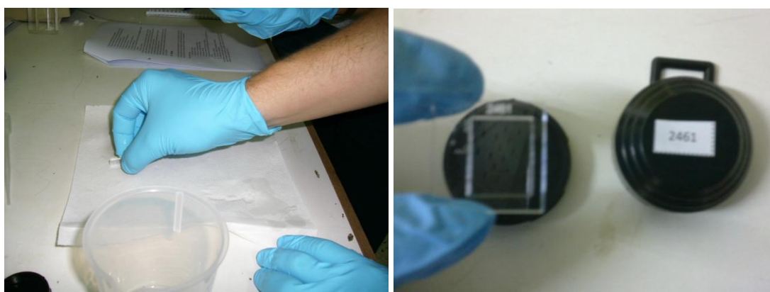
Σχήμα 4.5: Ελαφρύ σκούπισμα των ανιχνευτών με χαρτί και τοποθέτησή τους με την αριθμημένη όψη προς τα πάνω στην εσοχή της βάσης του κυπέλλου
