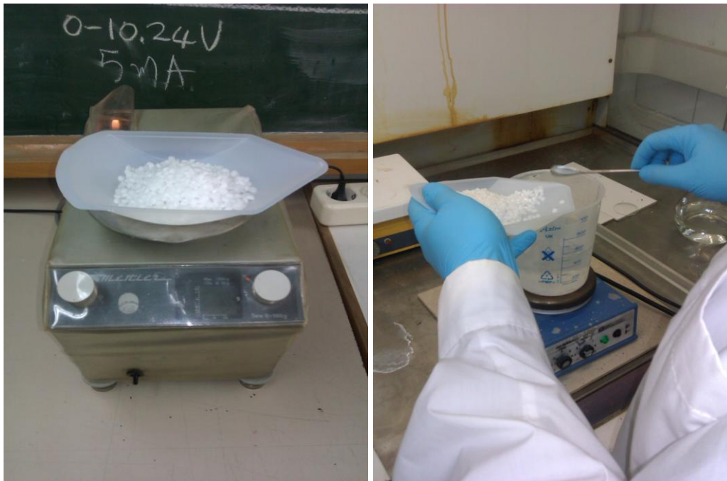
Σχήμα 4.6: Αναλογικός ζυγός τύπου Mettler P-1200 & Μαγνητικός αναδευτήρας τύπου IKAMAG RH
