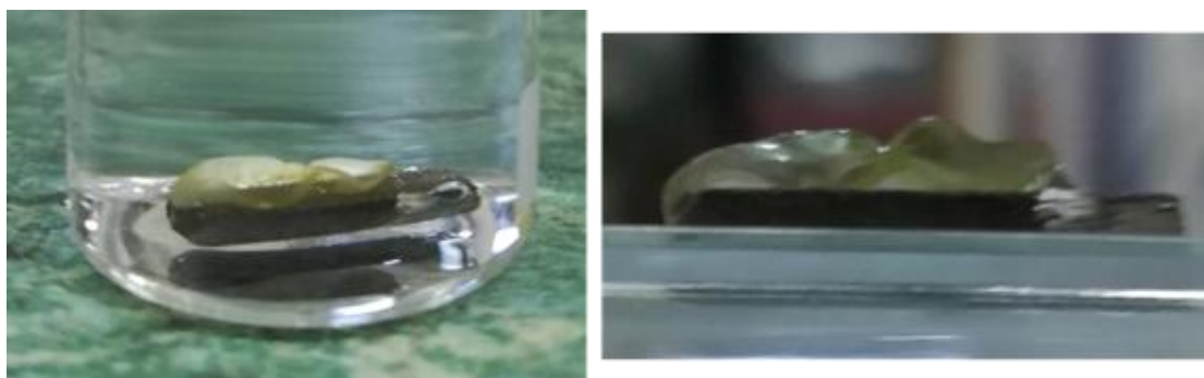
Εικόνα 7.4.2: Απεικόνιση της αστοχίας επικαλύψεων σε επιφάνειες που δεν είχαν υποστεί χημική επιφανειακή τροποποίηση μετά από εμβάπτιση σε υδατικό περιβάλλον
