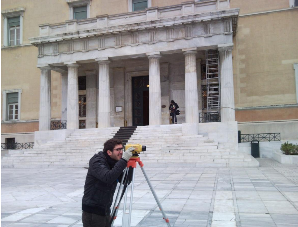
Εικόνα 3.11: Μετρήσεις γεωμετρικής χωροστάθμησης στον προαύλιο χώρο της Βουλής των Ελλήνων.
