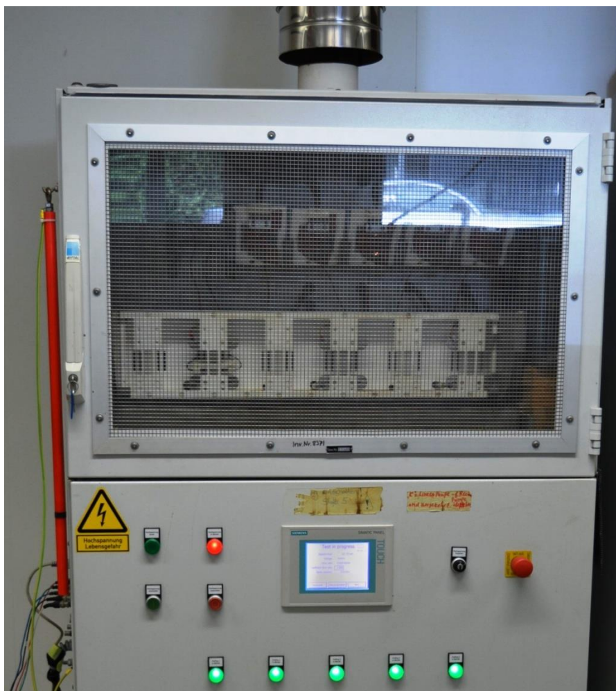
Εικόνα 2.6 Θάλαμος δοκιμής κεκλιμένου επιπέδου
