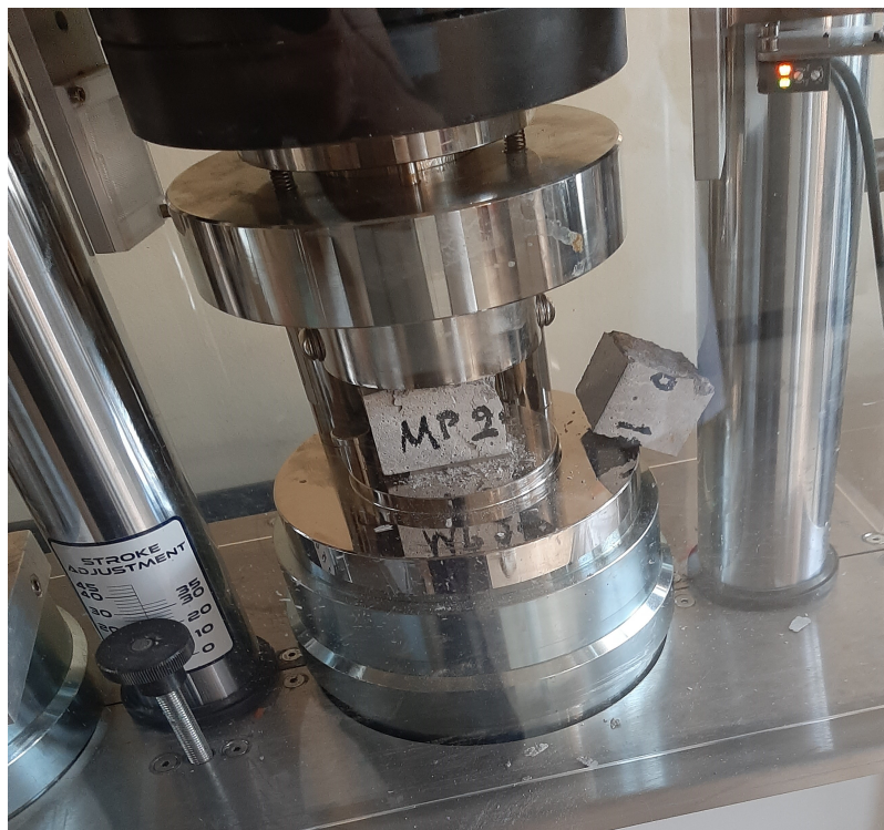
Εικόνα 3. 12: Δοκιμή σε θλίψη
