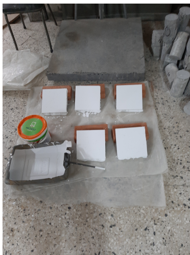
Εικόνα 3. 13: Μέθοδος εμβάπτισης δοκιμίων
