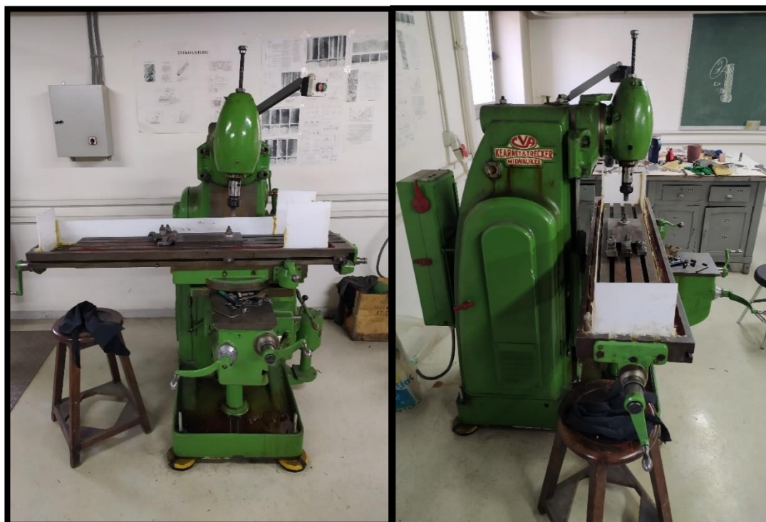
Εικόνα 20: Κάθετη τροποποιημένη φρεζομηχανή τύπου "KEARNEY TRECKER Horizontal Milling Machine Type No. 3CE"
