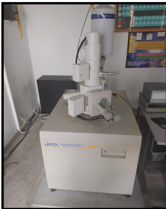
Εικόνα 24: Ηλεκτρονικό μικροσκόπιο σάρωσης SEM του Εργαστηρίου Ορυκτολογίας-Πετρολογίας-Κοιτασματολογίας τύπου Jeol JSM 6380LV
