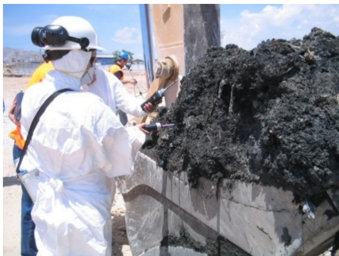
Οργανική και ανόργανη ρύπανση ανιχνεύεται εντός του μεγάλης έκτασης και βάθους ρυπασμένου οριζοντα (Μάνια Μπενίση ©, φωτογραφικό αρχείο, Αττικό Μετρό Α.Ε.)
