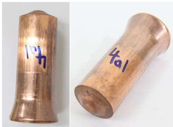
Εικόνα 23: Δοκίμιο Cu-Al 4 μετά την κατεργασία της διέλασης (μετά την εξόλκευση)
