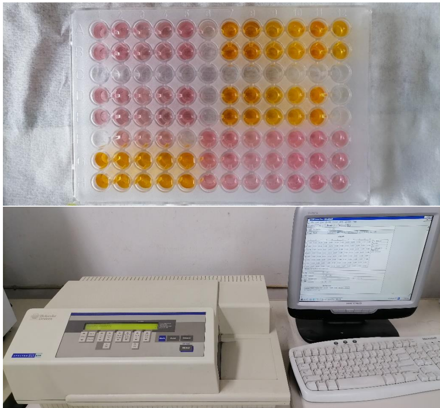
Εικόνα 7: Πάνω, η ειδική πλακέτα στην οποία φορτώνονται 250 \mu\text{L} από το κάθε διάλυμα και κάτω, το φωτόμετρο Microplate reader στο οποίο τοποθετείται η πλακέτα και μετρώνται οι απορροφήσεις των διαλυμάτων στα εκάστοτε nm.
