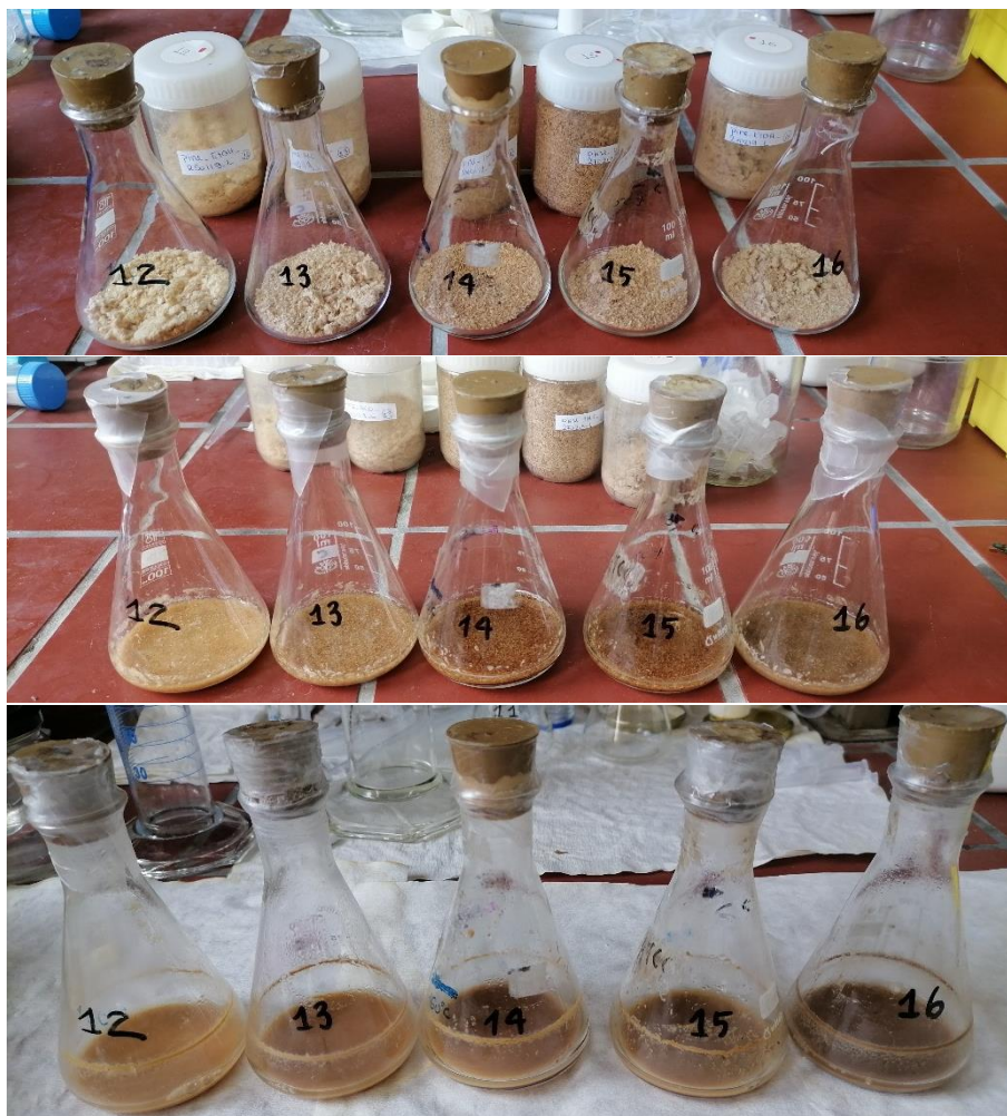
Εικόνα 3: Από πάνω προς τα κάτω, το στερεό λιγνινοκυτταρινούχο υλικό στις κωνικές φιάλες, το ομογενοποιημένο μίγμα στερεού λιγνινοκυτταρινούχου υλικού και ενζυμικού διαλύματος πριν την υδρόλυση και το υδρόλυμα που προκύπτει μετά τη δράση του Cellic CTec 2.
