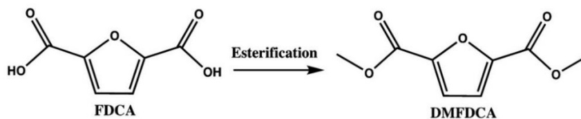
Σχήμα 10: Η χημική δομή του FDCA και της εστεροποιημένης μορφής του DMFDCA [23].
