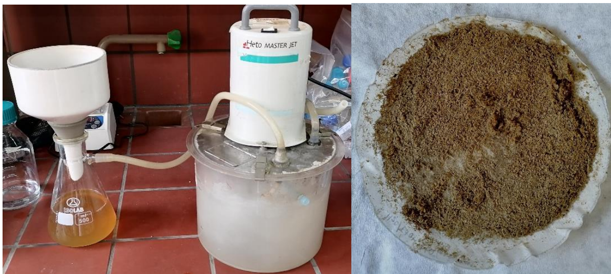
Εικόνα 2: Αριστερά, η διάταξη διήθησης υπό κενό και δεξιά, το στερεό κλάσμα του προκατεργασμένου υλικού μετά τη διήθηση.
