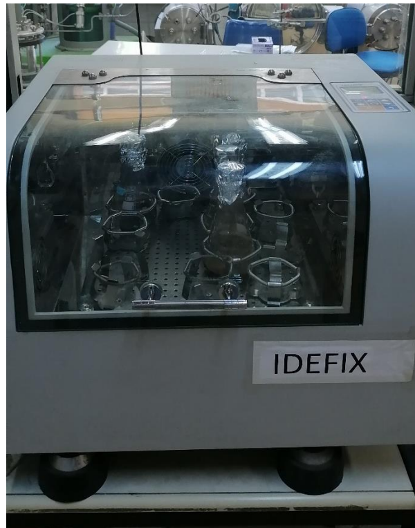
Εικόνα 4: Επωαστήρας για την υδρόλυση των λιγνινοκυτταρινούχων υλικών.
