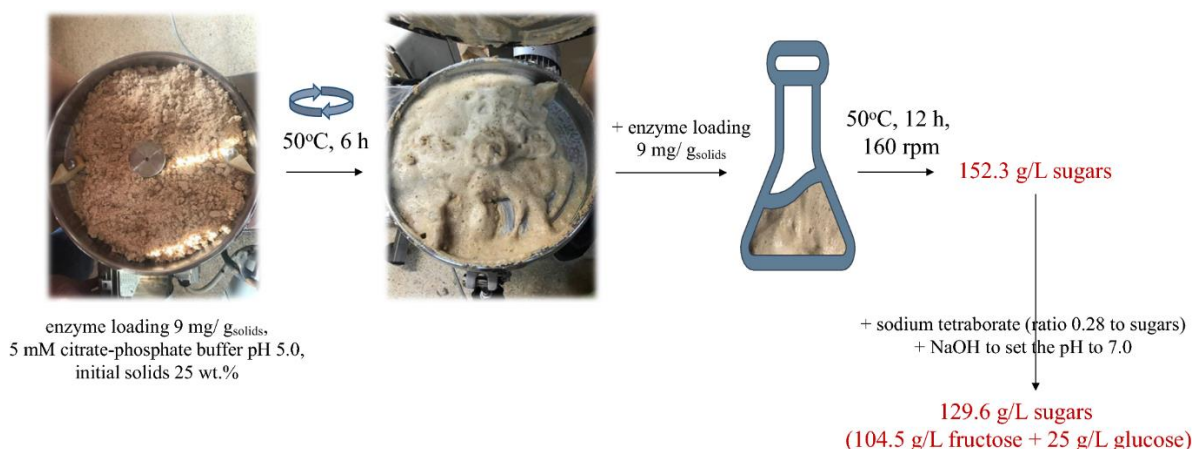
Σχήμα 19: Σχηματική απεικόνιση αρχικά της μεγαλύτερης κλίμακας υδρόλυσης με αυξημένη αρχική συγκέντρωση στερεών, ακολουθούμενη από τη μικρότερη υδρόλυση και στη συνέχεια της ισομερείωσης για την παραγωγή φρουκτόζης τελικής συγκέντρωσης 104.5 g/L [42].
