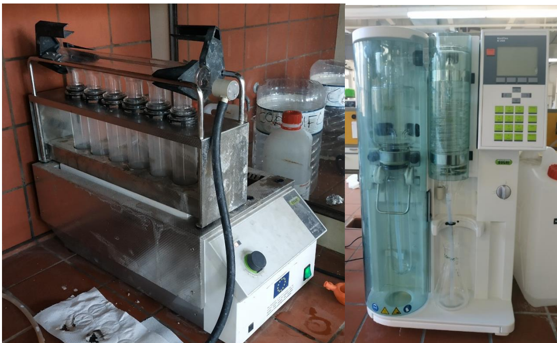
Εικόνα 5. 7 Συσκευή χώνευσης δειγμάτων (αριστερά), συσκευή απόσταξης KjelFlex K-360 για την απελευθέρωση αμμωνίας (δεξιά)
