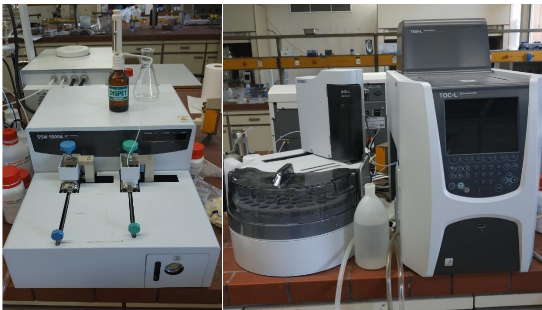
Εικόνα 5. 8 Όργανο SHIMADZU SSM-5000A Solid Sample Module για τη μέτρηση του ολικού οργανικού άνθρακα (αριστερά) και Όργανο SHIMADZU TOC-L Total Organic Carbon Analyzer για τη μέτρηση του διαλυτού ολικού οργανικού άνθρακα (δεξιά)
