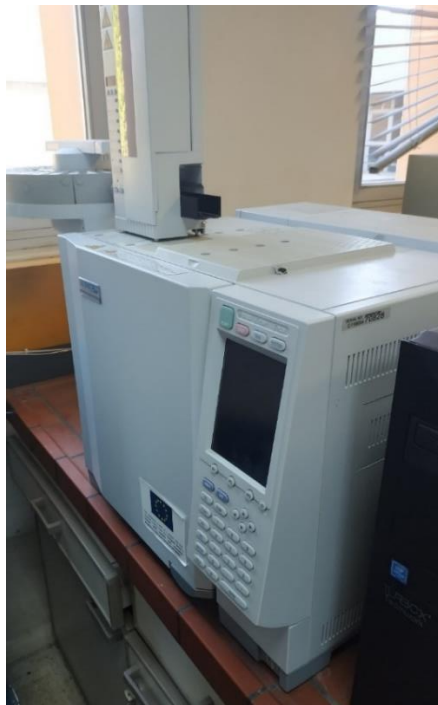
Εικόνα 5. 3 Αέριος χρωματογράφος Shimadzu GC-2010 plus για μέτρηση πτητικών λιπαρών οξέων
