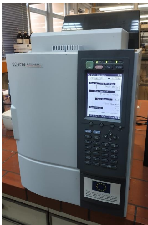
Εικόνα 5. 4 Αέριος χρωματογράφος Shimadzu GC-2014 για τη μέτρηση της περιεκτικότητας του βιοαερίου σε μεθάνιο
