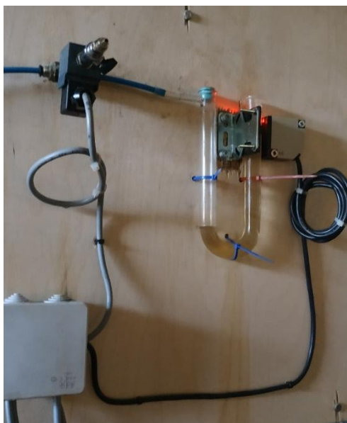
Εικόνα 5. 6 Κλικογράφος για τη μέτρηση της παροχής του παραγόμενου βιοαερίου
