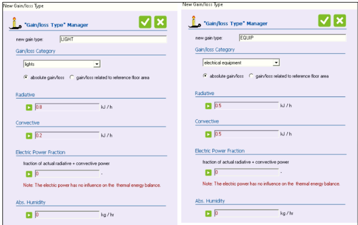
Σχήμα 5. 34: Κέρδος από ακτινοβολία και από συναγωγή για τα κέρδη φωτισμού και συσκευών.
