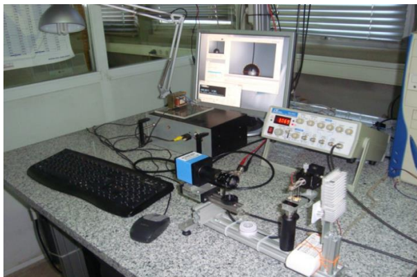
Εικόνα 3.11: Πειραματική διάταξη μετρήσεων γωνίας επαφής
