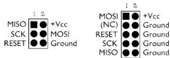
ISP Connectors: 6-pin & 10-pin Σχήμα 3.20
