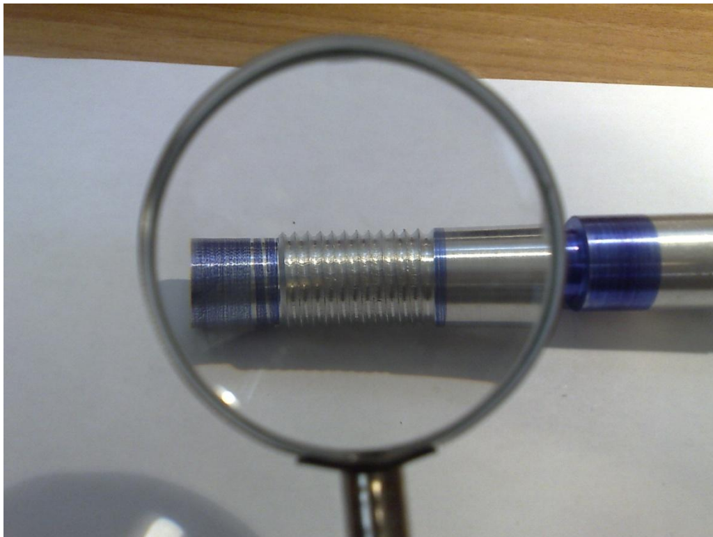
Σχήμα 4.19 Σπείρωμα βήματος 2.5mm σε αλουμίνιο
