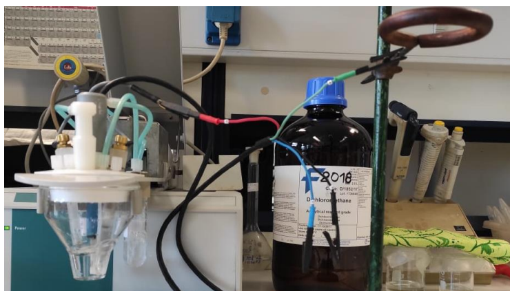
Εικόνα 32: Διάταξη για screen-printed ηλεκτρόδια
