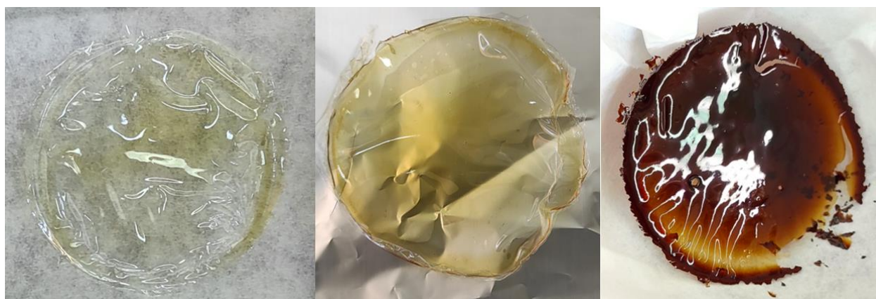
Εικόνα 20. Από αριστερά προς τα δεξιά: 1. Φιλμ χιτοζάνης F 1 με οξικό οξύ, 2. Φιλμ χιτοζάνης F 9 με 1% w/v εκχύλισμα E/Bet:LA:W, 3. Φιλμ χιτοζάνης F 11 με 0.5% w/v E/Bet:Gly και οξικό οξύ
