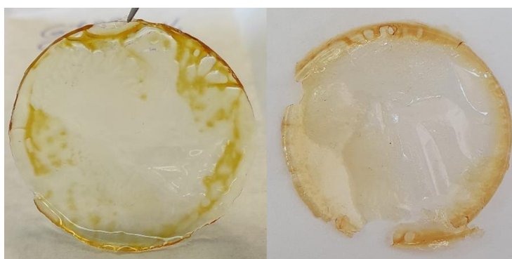
Εικόνα 22. Αριστερά: F 15 Φιλμ CAGE (1:2) με προσθήκη οξικού οξέος μετά το CAGE. Δεξιά: F 16 Φιλμ CAGE (1:2) με προσθήκη χιτοζάνης σε διάλυμα οξικού οξέος.
