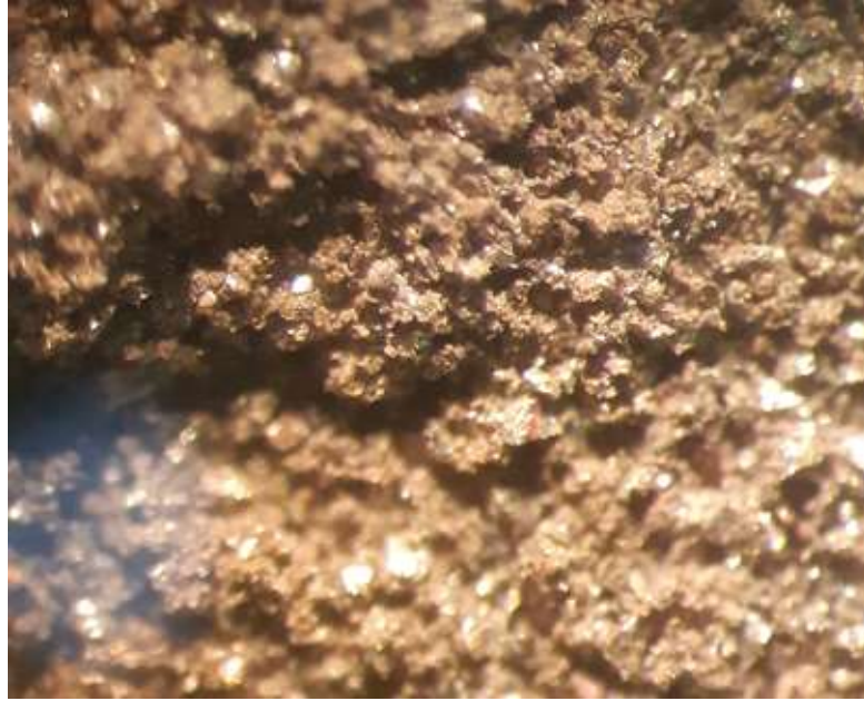
Εικόνα 26. Δοκιμή 4, pH=9.5, περιεκτικότητα Zn 4,87%
