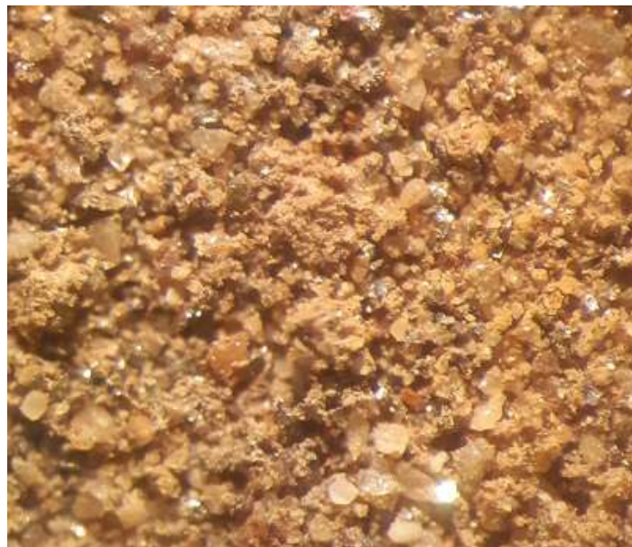
Εικόνα 29. Δοκιμή 2, pH=8.5, περιεκτικότητα Fe 40,89%
