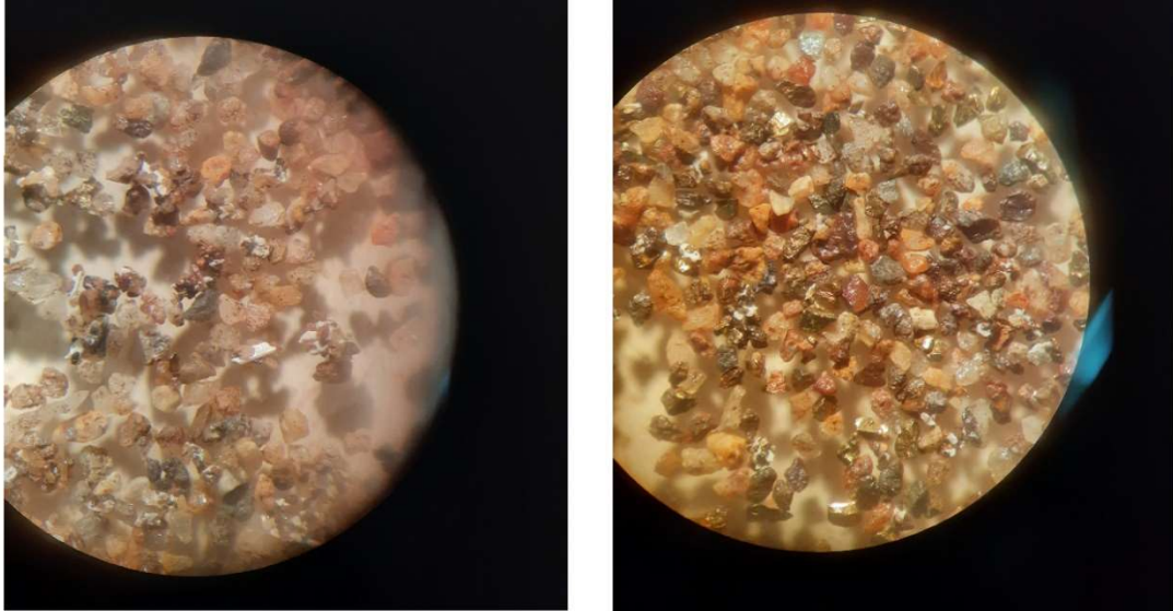
Εικόνα 14α: Μέγεθος -300+150\ \mu\text{m} , επιπλεύσαν (αριστερά) και βυθισθέν (δεξιά) στο 2,97
