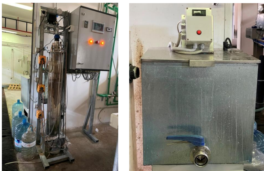
Εικόνα 4: Πειραματική διάταξη αντιδραστήρα SBR. Αριστερά: Η συνολική (κύρια) διάταξη της διεργασίας. Δεξιά: Δοχείο τροφοδοσίας υγρού αποβλήτου-influent (παγολεκάνη, influent tank).
