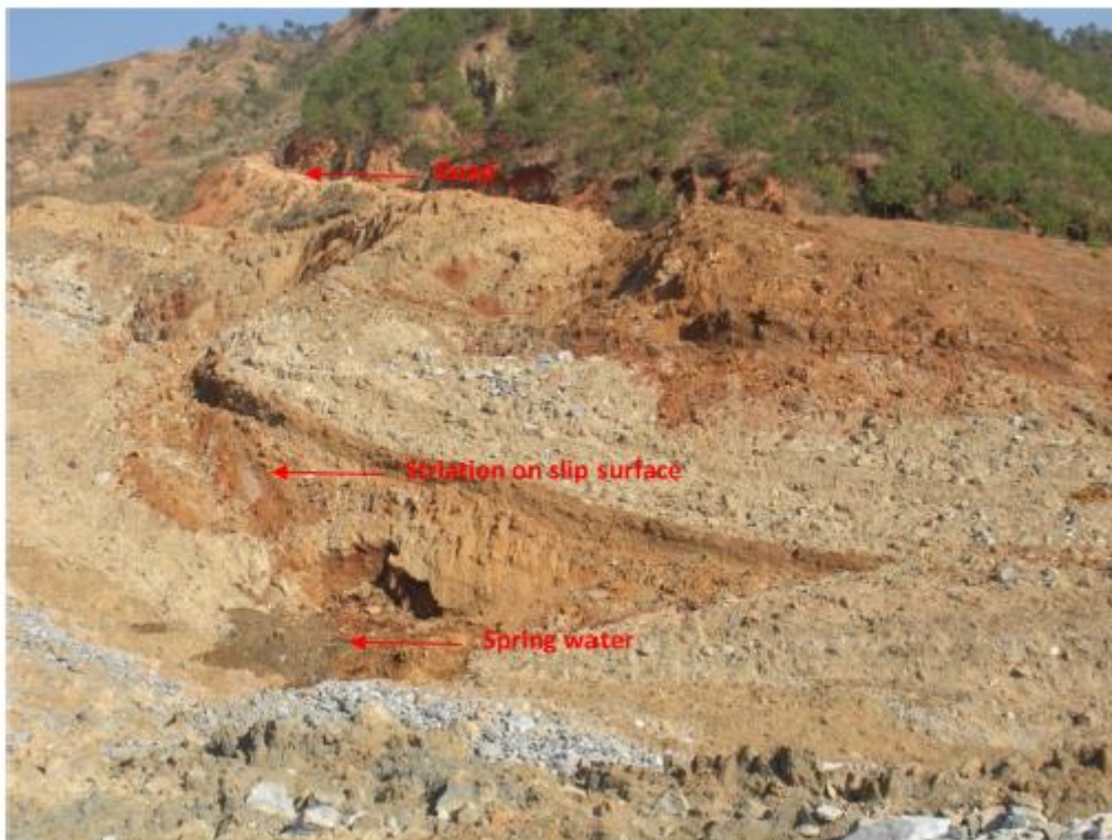
Εικόνα 77: Διεπαφές και πηγές στην επιφάνεια ολίσθησης (Eid H. κ.α. 2000)
