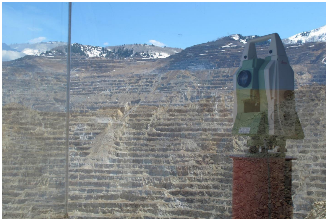
Εικόνα 43:Ρομποτικός σταθμός παρακολούθησης (RTS) για την μέτρηση παραμορφώσεων στα πρανή (Rio Tinto Kennecott 2013)
