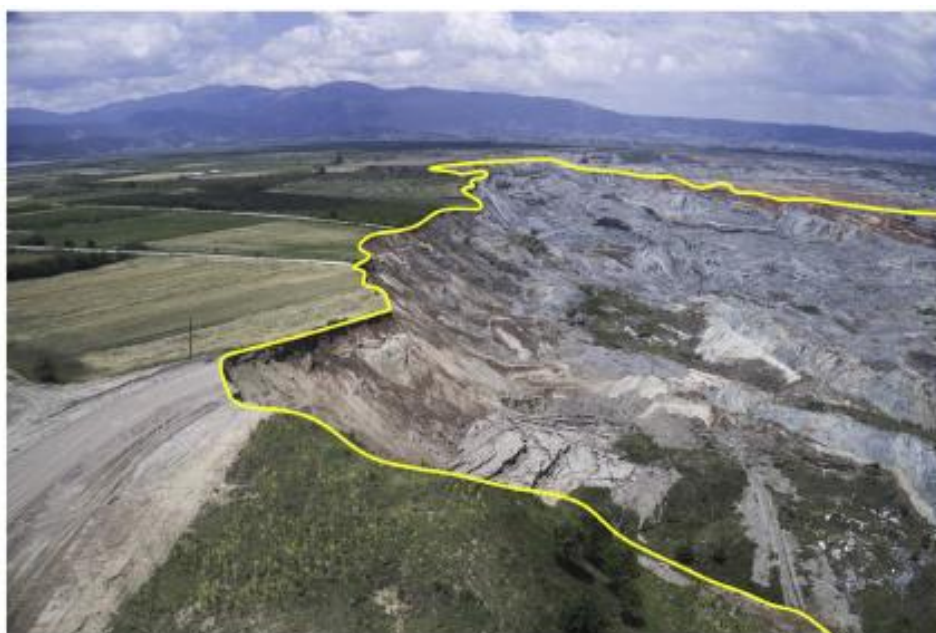
Εικόνα 60: Το μέγεθος της κατολίσθησης στο ορυχείο του Αμυνταίου (φωτογραφία ιδιοκτησίας της Eurokinissi)
