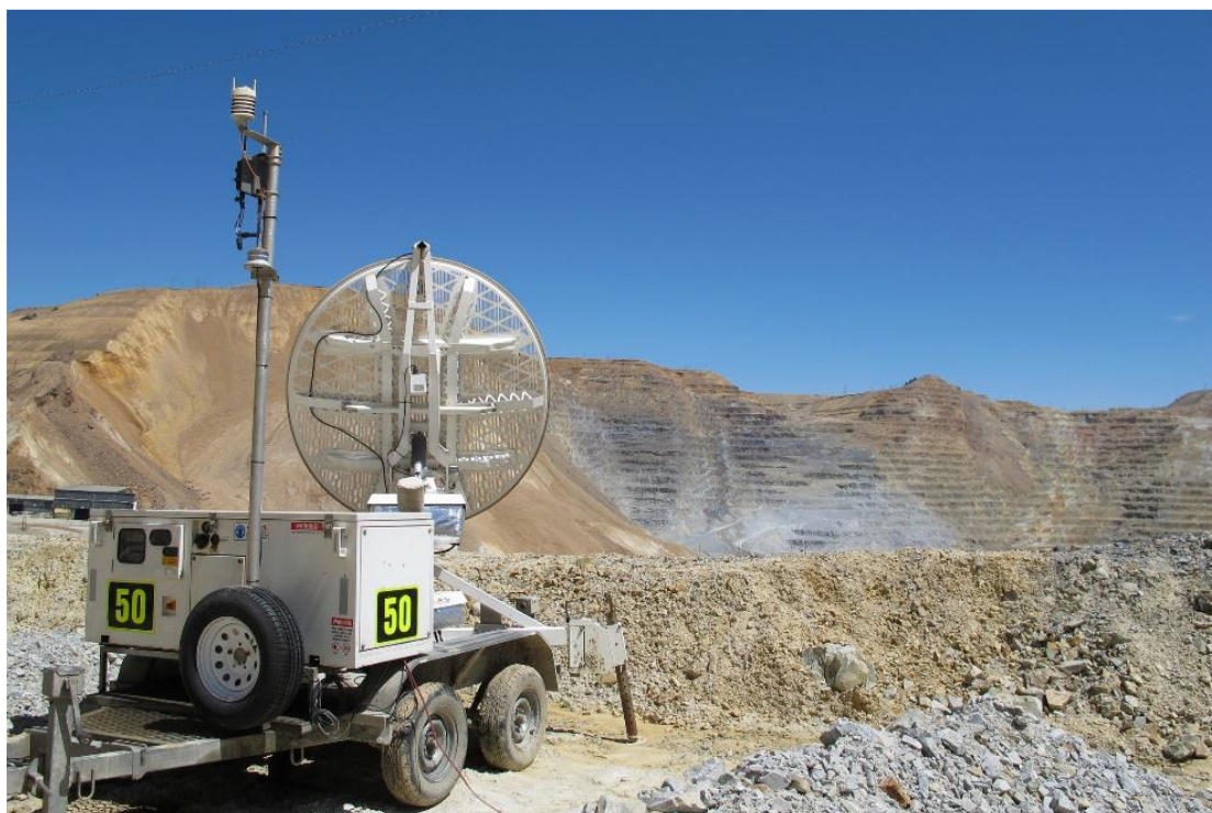
Εικόνα 44:Ραντάρ ευστάθειας πρανούς Groundprobe (Rio Tinto Kennecott 2013)
