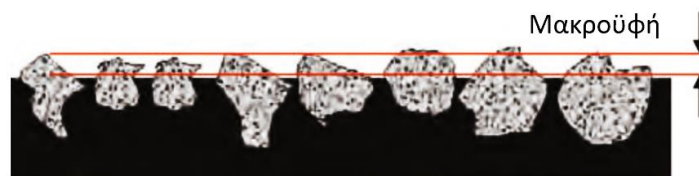
Εικόνα 3.19: Μακροϋφή στρώσης κυκλοφορίας
