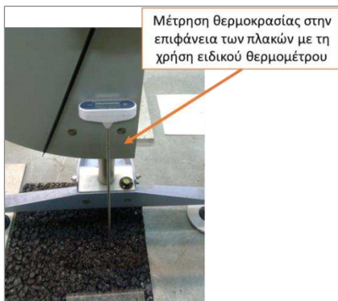
Εικόνα 5.23: Μέτρηση θερμοκρασίας στην επιφάνεια των πλακών
