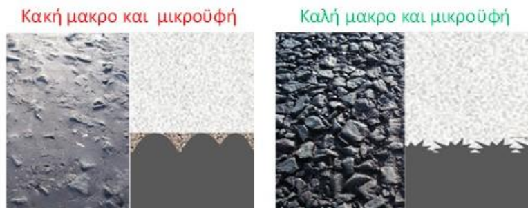
Εικόνα 3.15: Επιφάνειες οδοστρώματος με κακή και καλή μακροϋφή και μικροϋφή
