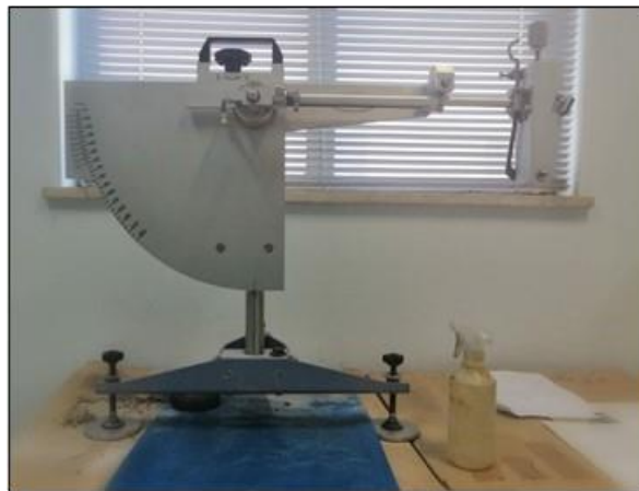
Εικόνα 4.7: Βρετανικό εκκρεμές – BPT (British Pendulum Tester)
