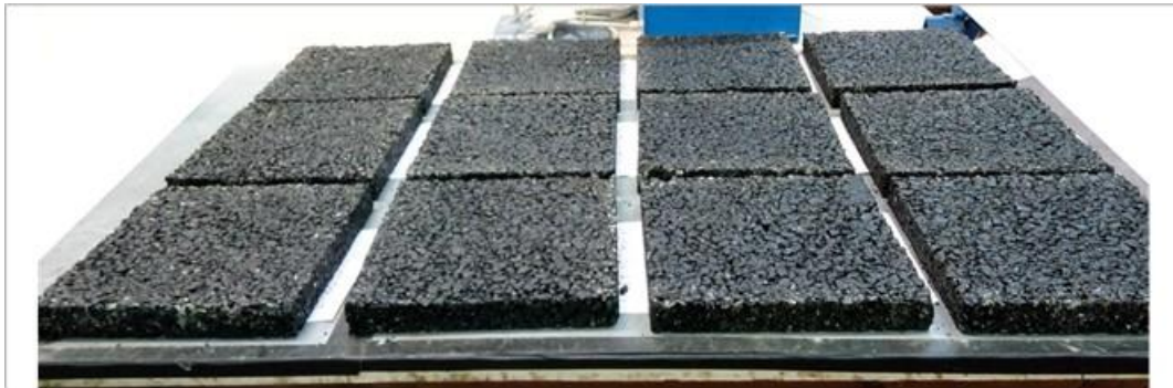
Εικόνα 5.10: Πλάκες με περιεκτικότητα ανακυκλωμένου ελαστικού
