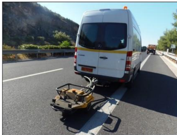
Εικόνα 4.6: Επιτόπου μέτρηση με το σύστημα GripTester (MK2) του Εργαστηρίου Οδοποιίας ΕΜΠ
