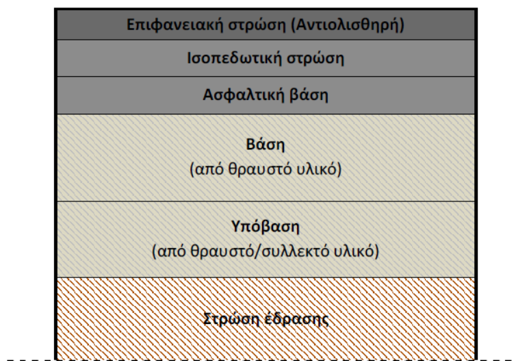
Εικόνα 2.1: Τυπική διατομή εύκαμπτου οδοστρώματος
