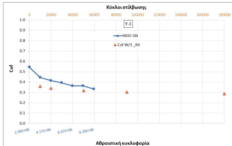
Εικόνα 7.10: Σύζευξη καμπύλων στίλβωσης, επιτόπου στοιχεία -τμήμα Y3 & εργαστηρίου -δείγμα R0
