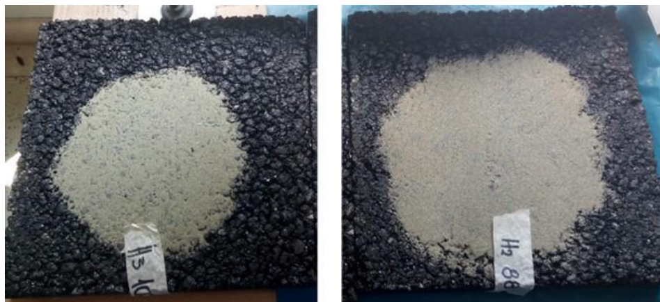
Εικόνα 5.22: Κηλίδα της άμμου σε πλάκες με διαφορετικά χαρακτηριστικά
