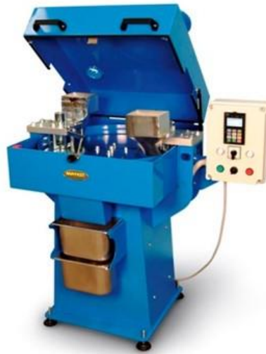
Εικόνα 2.6: Συσκευή για την δοκιμή απότριψης - AAV
