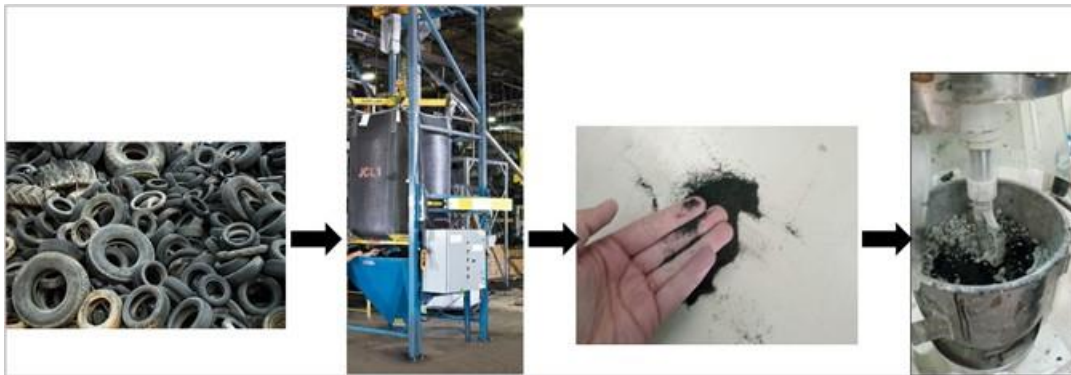
Εικόνα 5.8: Προέλευση και χρήση ανακυκλωμένου ελαστικού σε έργα οδοποιίας (Pomoni et al. 2020a)
