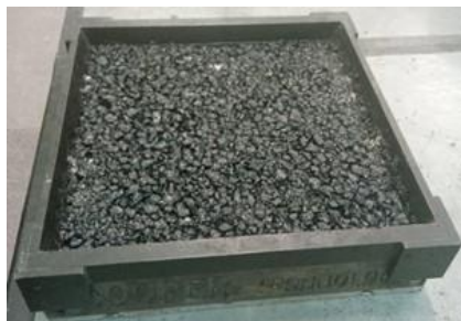
Εικόνα 5.4: Παρασκευασμένη πλάκα εντός του καλουπιού (μετά την συμπίκνωση)
