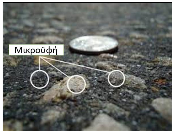
Εικόνα 3.16: Μικροϋφή αδρανών ασφαλτομίγματος
