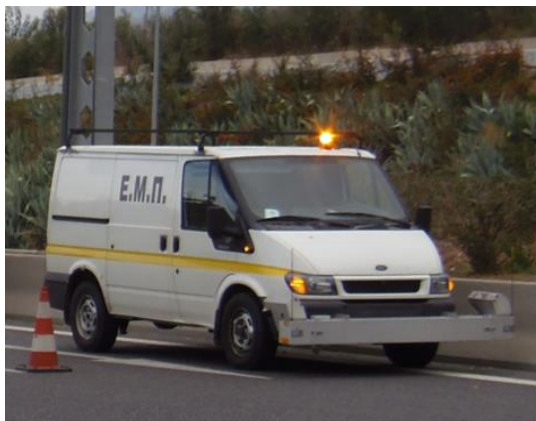
Εικόνα 3.22: Μέθοδος μέτρησης μακροϋφής με το σύστημα Laser Profiler
