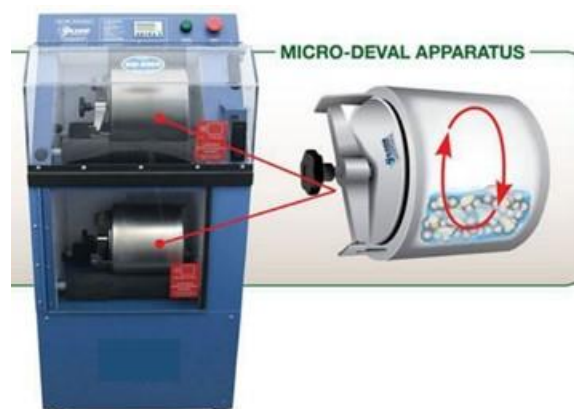
Εικόνα 2.4: Συσκευή για την δοκιμή απότριψης - Micro-deval
