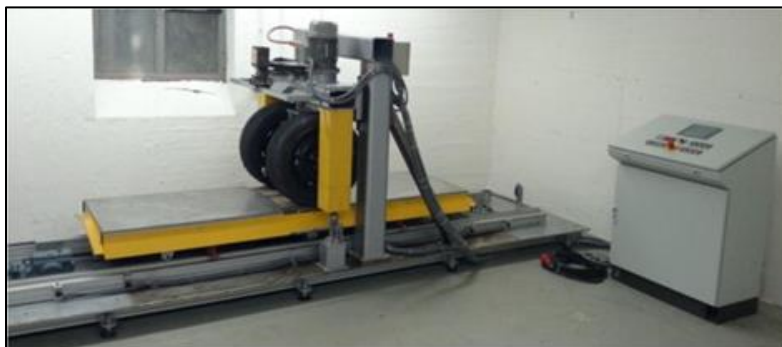
Εικόνα 3.48: Συσκευή Aachen polishing machine (Aachen, Germany)
