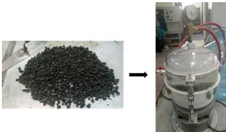
Εικόνα 5.2: Δοκιμή Rise σε χαλαρό ασφαλτόμιγμα τύπου HMA
