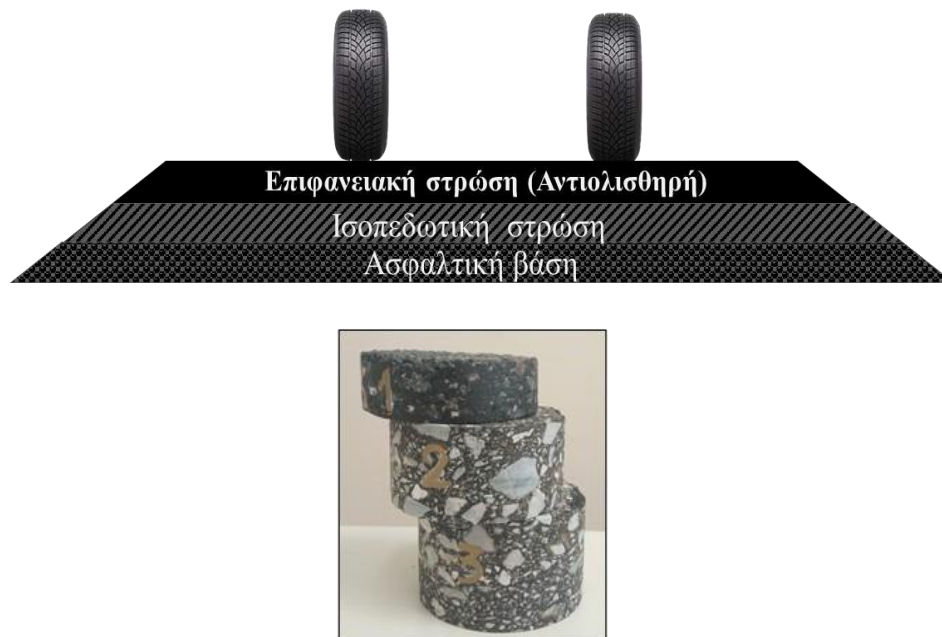
Εικόνα 2.11: Επιμέρους υπό-στρώσεις της ασφαλτικής στρώσης
