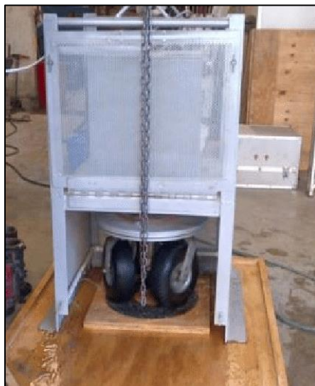
Εικόνα 3.47: Συσκευή Auckland polishing machine (Auckland, New Zealand)
