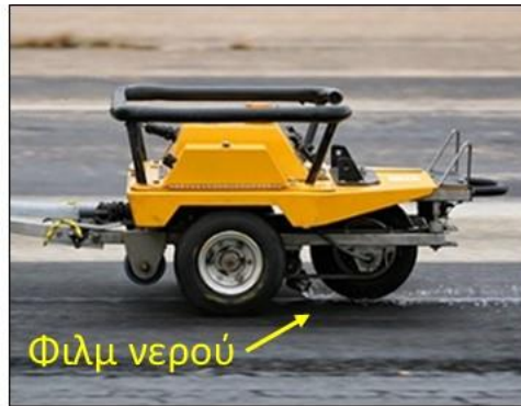
Εικόνα 4.5: Παροχή νερού κάτω από το πρότυπο ελαστικό
