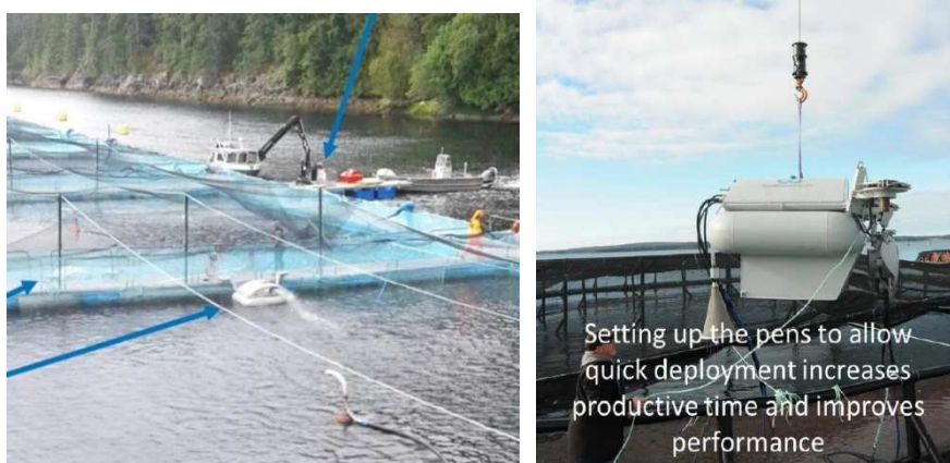
Εικόνα 7.10: Ρομποτικό σύστημα καθαρισμού δικτυοκλωβών
