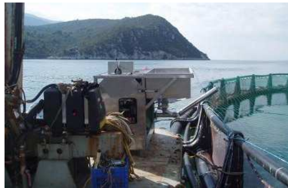
Εικόνα 7.7: Σύστημα ταΐσματος τύπου «κανονάκι» για μονάδες ιχθυοκαλλιέργειας Πηγή: ΝΑΥΣ – ΙΩΑΝΝΑ Ν. ΑΡΓΥΡΟΥ Μ.Ε.Π.Ε., 2020α.
