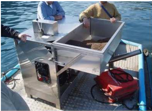
Εικόνα 7.7: Σύστημα ταΐσματος τύπου «κανονάκι» για μονάδες ιχθυοκαλλιέργειας Πηγή: ΝΑΥΣ – ΙΩΑΝΝΑ Ν. ΑΡΓΥΡΟΥ Μ.Ε.Π.Ε., 2020α.
