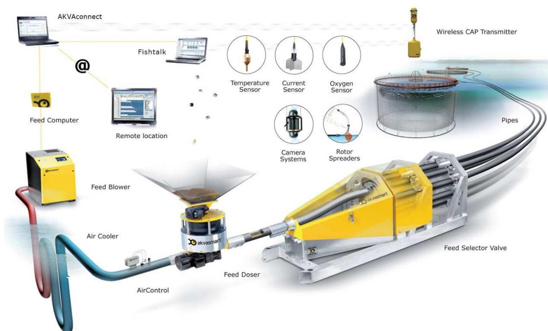
Εικόνα 7.5: Αυτόματο σύστημα διατροφής μονάδων ιχθυοκαλλιέργειας Πηγή: AKVA Group
