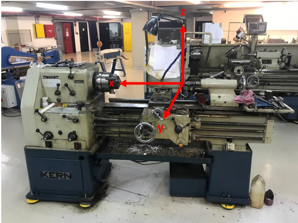
Εικ. 3.3 Σύστημα αξόνων που χρησιμοποιήθηκε.
