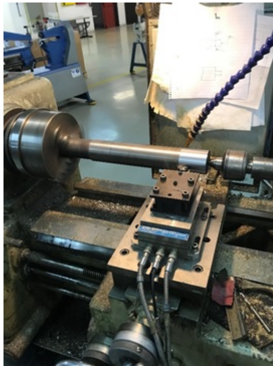
Εικ. 3.4 Δοκίμιο κατά την ψυχρή επανάληψη του πειράματος.
