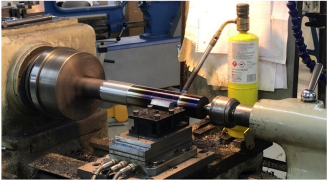
Εικ. 3.5 Δοκίμιο κατά την θερμή επανάληψη του πειράματος.
