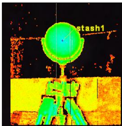
Εικόνα 4.1: Αποτέλεσμα της σάρωσης του σφαιρικού στόχου και του καθορισμού του κέντρου του. Picture 4.1: Result of the sphere HDS target scanning and the selection of it's centre.
