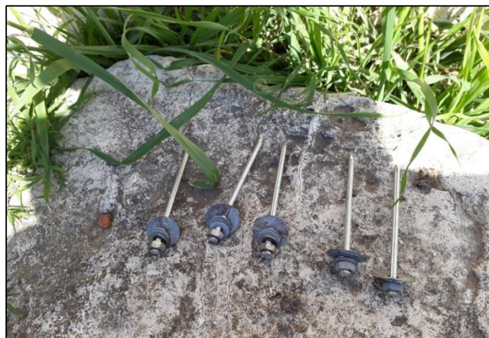
Εικόνα 3.6: Σήμανση των κορυφών του δικτύου. Picture 3.6: Marking of the geodetic network points.
