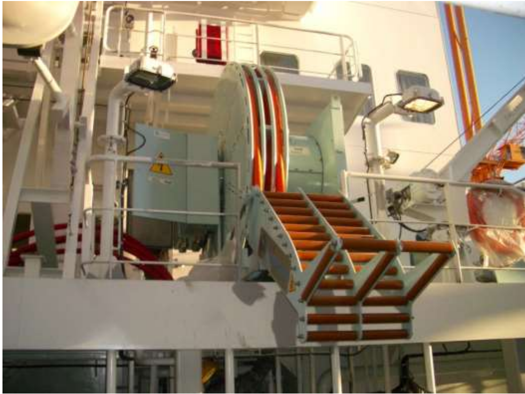
Σχήμα 8.7 Διάταξη καλωδίων πάνω στο κατάστρωμα του πλοίου
