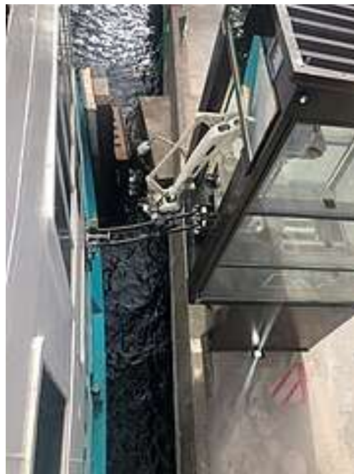
Σχήμα 8.8 Ρομποτικός βραχίονας σύνδεσης καλωδίων
