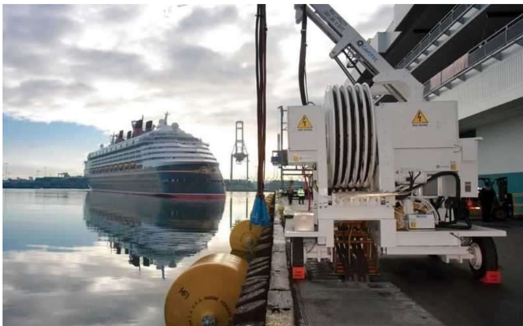
Σχήμα 8.5 Γερανοφόρο όχημα σύνδεσης καλωδίων
