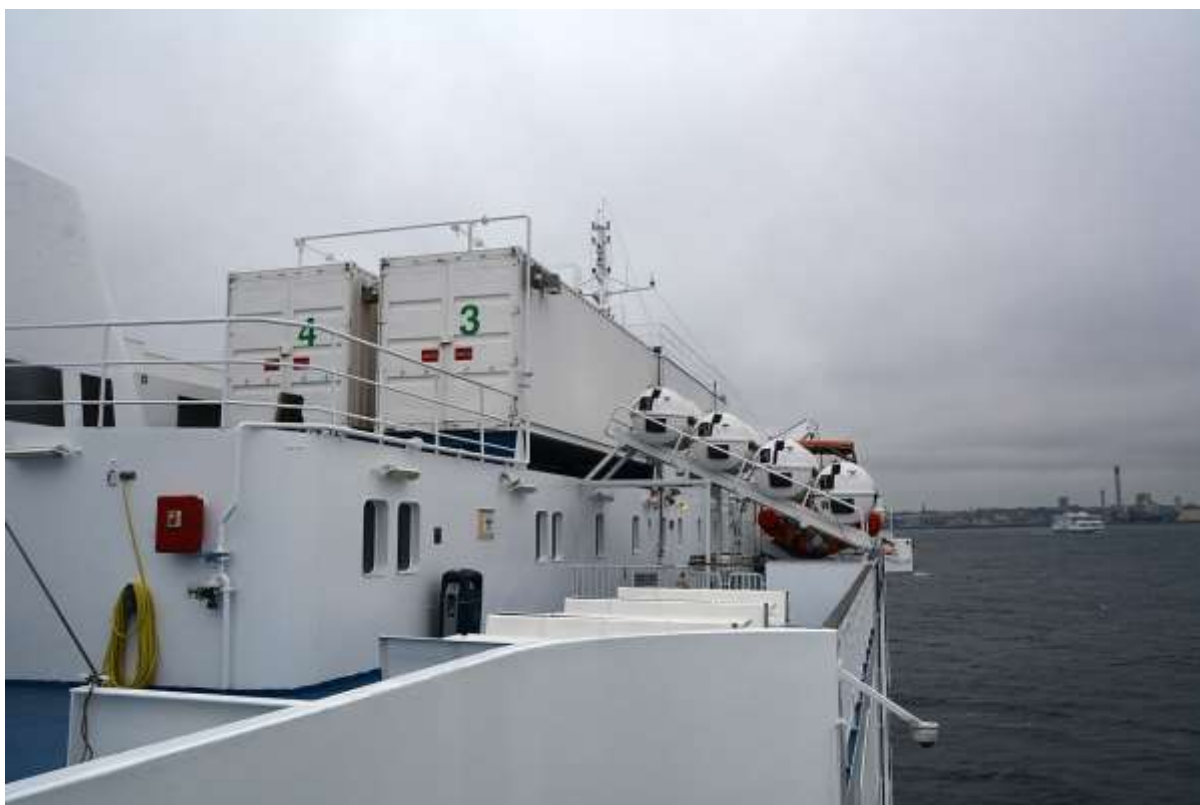
Σχήμα 5.10 Τα containers που περιέχουν τις μπαταρίες στο Tycho Bahre
