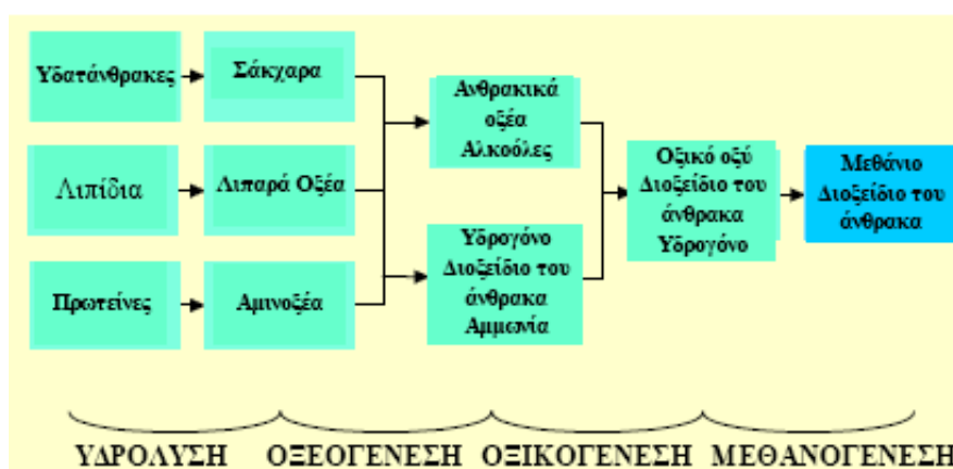
Διάγραμμα 2-1 Διεργασία Αναερόβια Χώνευσης
