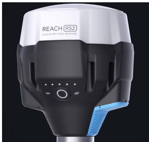
Εικόνα 14. Δέκτης GPS με ονομασία Reach RS2 από την εταιρεία Emlid. Πηγή [21]
