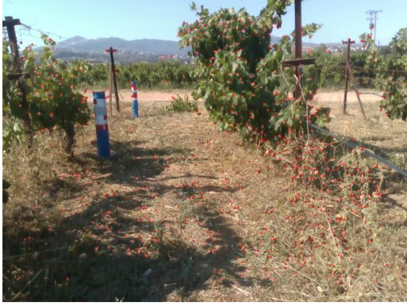
Εικόνα 42. Φωτογραφικό καρέ στο οποίο φαίνονται με κόκκινο χρώμα τα σημεία που εξήχθησαν για το πρώτο βήμα για την δημιουργία μιας οπτικής οδομετρίας με χρήση του πακέτου RTAB-Map.
