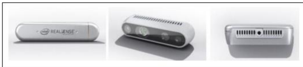
Εικόνα 22 Διάφορες όψεις της κάμερας Intel D435i. Πηγή [37]
