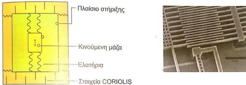
Εικόνα 7. Διάταξη ηλεκτρομηχανικού γυροσκοπίου. Πηγή [20]
