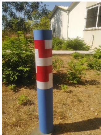
Εικόνα 46. Τεχνητά σημεία αναφοράς (landmarks) το οποίο είναι τυλιγμένο με ανακλαστική ταινία (άσπρη και κόκκινη στρώση).
