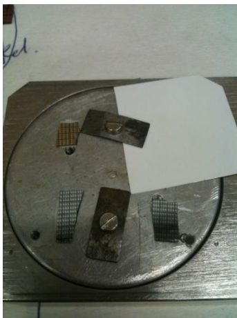
Εικόνα 7.18(α) Τα τρία πρώτα δείγματα μαζί με το φύλλο ZnS όπως τοποθετήθηκαν στην μεταλλική βάση.
