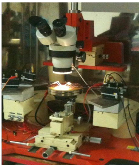
Εικόνα 8.5 Στην εικόνα διακρίνεται το μικροσκόπιο, οι μεταλλικές βελόνες καθώς και το δείγμα που είναι τοποθετημένο στην μεταλλική βάση.
