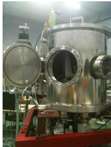
Εικόνα 7.14(δ) Ο θάλαμος ακτινοβολήσης μέσα στον οποίο βρίσκονταν τα δείγματα.
