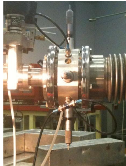
Εικόνα 7.14(β) Ο collimator 1 που βρίσκεται έξω από τον θάλαμο ακτινοβολήσης.
