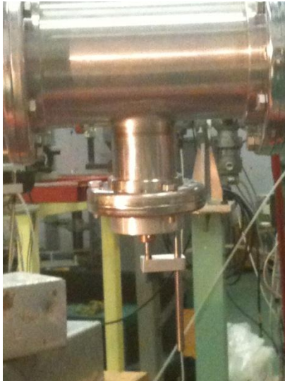
Εικόνα 7.14(α) Το foil/degrader αλουμινίου.
