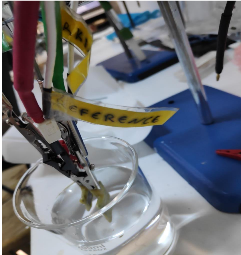
Εικόνα 19: Διάταξη 2 ηλεκτροδίων, όπου το ένα λειτουργεί ως εργασίας και αναφοράς 1 και το δεύτερο ως βοηθητικό και αναφοράς 2.
