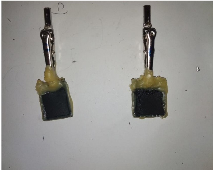
Εικόνα 16: Τελική μορφή ηλεκτροδίων για την διάταξη των 2 ηλεκτροδίων.
