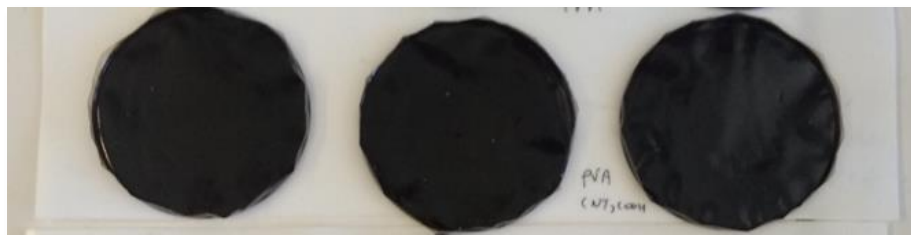
Εικόνα 14: Μεμβράνες μετά την χύτευση σε τριβλίο.
