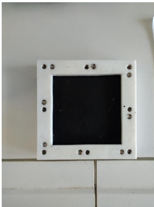
Εικόνα 15:Καλούπι χύτευσης του υλικού της μεμβράνης
