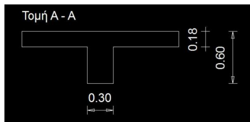
Σχήμα 2.96: Τομή εσωτερικών δοκών
