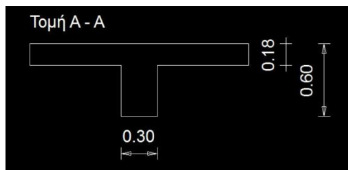
Σχήμα 2.16: Τομή εσωτερικών δοκών
