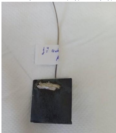
Εικόνα 22: Φωτογραφία του ηλεκτροδίου της καθόδου μετά το τέλος του κύκλου ανάκτησης του αλουμινίου.
