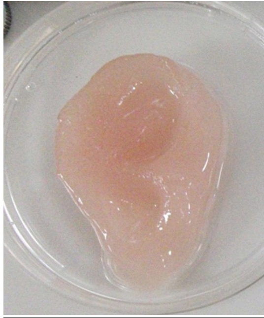
Εικόνα 53: Μια φωτογραφία ενός προσθετικού φυσικού αυτιού, τρισδιάστατα εκτυπωμένου, από PDMS, με το σωστό χρώμα και υφή.
