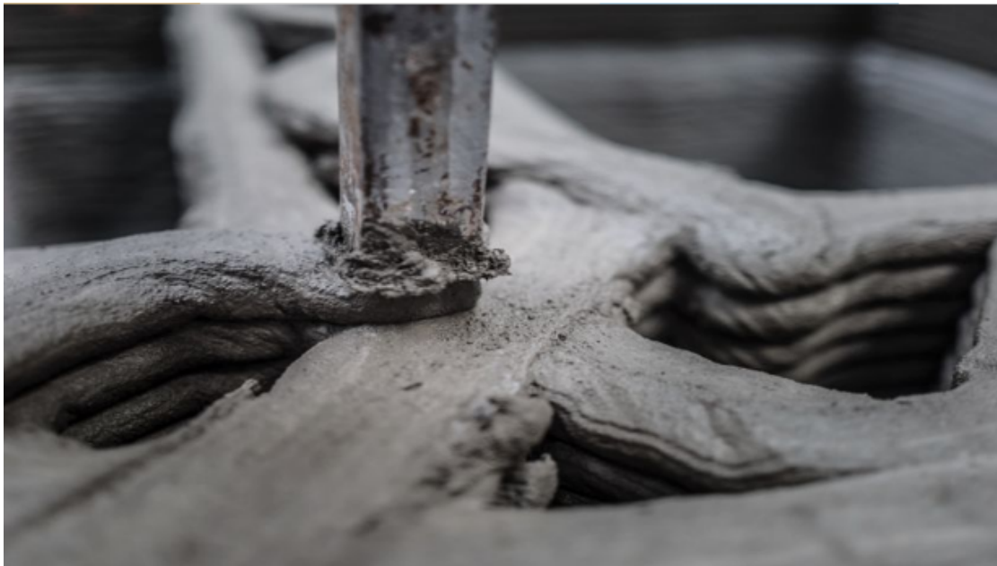
Εικόνα 101: Η εικόνα δείχνει ένα τρισδιάστατο τυπωμένο δομικό υλικό επεξεργασμένο από βιομηχανικά στερεά απόβλητα και αστικές κατεδαφίσεις στερεών αποβλήτων. 31
