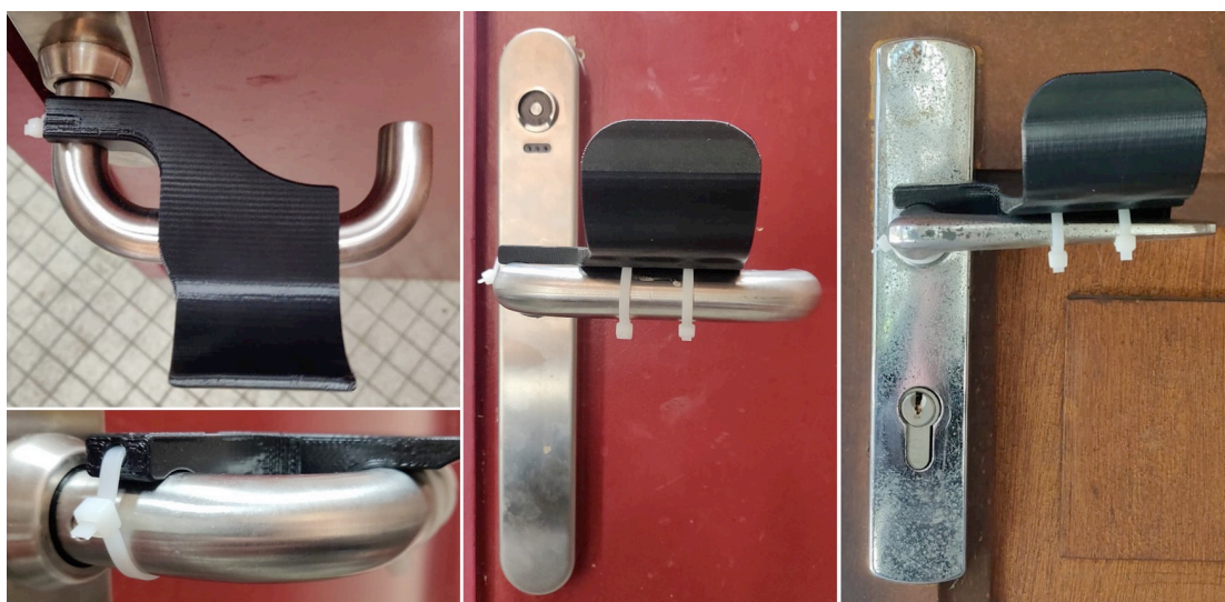
Εικόνα 74: Ανέπαφα χερούλια ανοίγματος θυρών με τη χρήση καλωδίων σε δύο τύπους λαβών πόρτας.[121]
