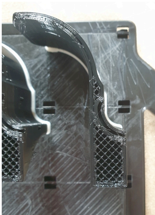
Εικόνα 72: Χαρακτηριστικά εκτύπωσης σε συσκευή J120: πάχος στρώσης = 0,33 mm, πυκνότητα πλήρωσης = 43%, πάχος τοιχώματος = 2 mm. Η χρήση της υποστήριξης βελτιστοποιήθηκε για τη μείωση του χρόνου μετά τη θεραπεία. [121]
