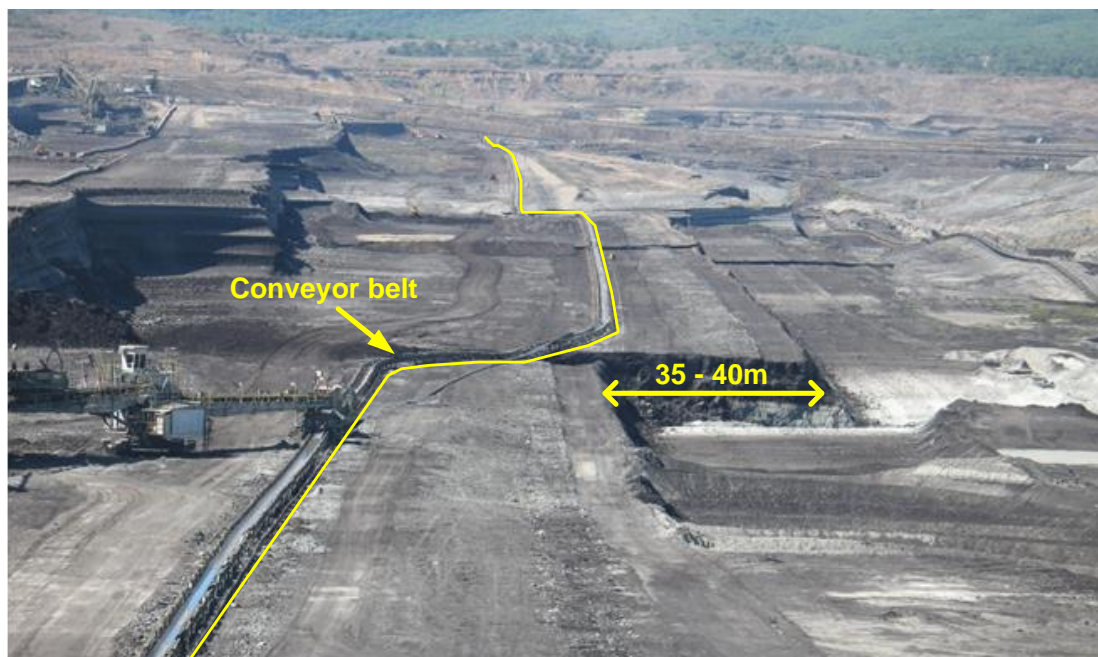
Εικόνα 13 Οριζόντιες μετατοπίσεις μίας βαθμίδας στο ορυχείο Χωρεμίου (νοτιοδυτικά της εκσκαφής) μετά την κατολίσθηση του 2013 (Roumpos et al. 2014)
