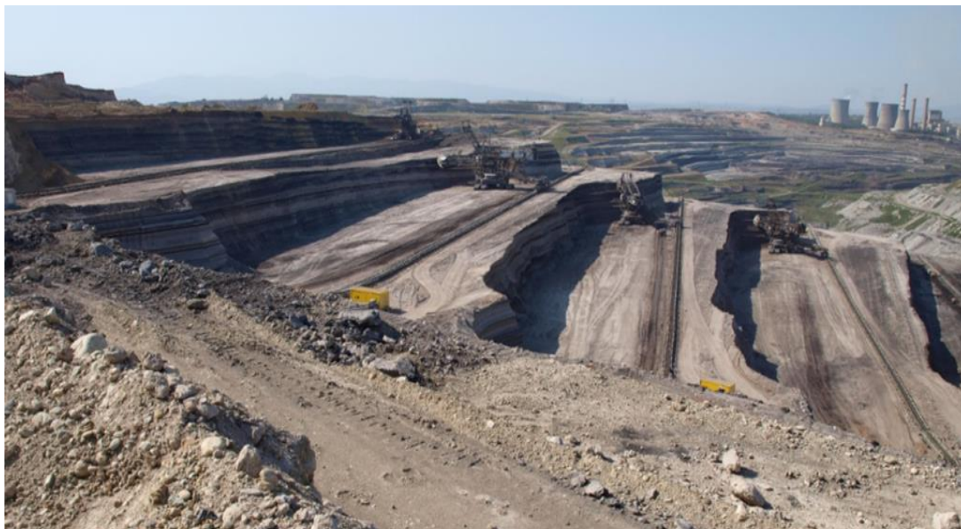
Εικόνα 3 Διαδοχικές βαθμίδες με καδοφόρους εκσκαφείς σε βαθύ λιγνιτωρυχείο (Kavvadas et al. 2018)
