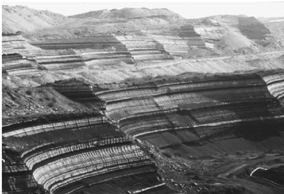
Εικόνα 5 Πολυστρωματική στρωματογραφία ελληνικών λιγνιτικών κοιτασμάτων (Galetakis et al. 2005)
