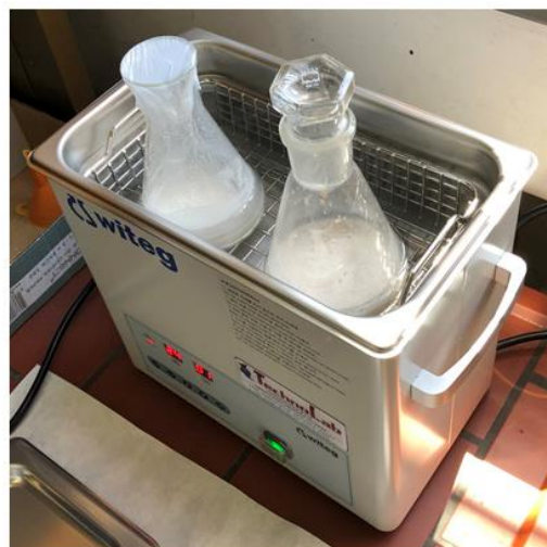
Εικόνα 40. Λουτρό υπερήχων (Witeg A22H Ultrasonic Bath) στο οποίο λαμβάνει χώρα η εκχύλιση του μυϊκού ιστού (διαυγές χρώμα) και των οργάνων (σκούρο χρώμα) του L. sceleratus .
