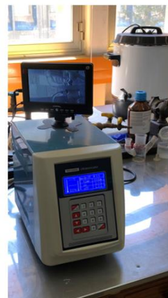
Εικόνα 31. Σύστημα αντίδρασης υπερήχων-μικροκυμάτων (Ultrasonic microwave reaction system) της εταιρίας Nanjing Xianou Instruments Manufacture Co., Ltd.
