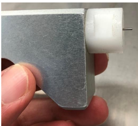
Εικόνα 42. Εξάρτημα της συσκευής του electro spraying. Πάνω δεξιά φαίνεται το μεταλλικό ακροφύσιο από όπου λαμβάνει χώρα ο ψεκασμός.
