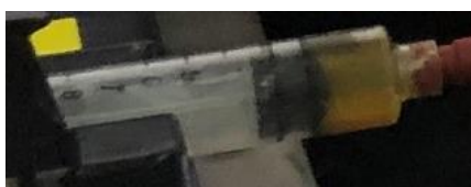
Εικόνα 46. Εμφανής ασυνέχεια στο διάλυμα (διαχωρισμός της ζεΐνης με το εκχύλισμα τετραδοτοξίνης).
