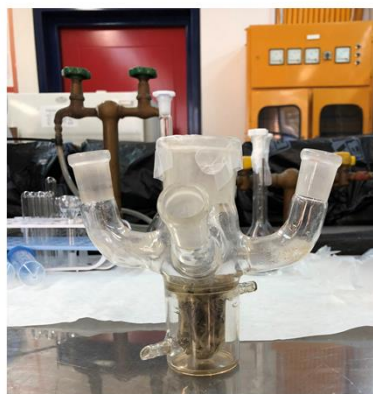
Εικόνα 30. Ανάμιξη 10 g ακάνθων του λειοντόφαρου P.miles με 20 mL ρυθμιστικού διαλύματος φωσφορικών 10 mM (pH 7.0) που περιέχει 1 mM CaCl_2 .
