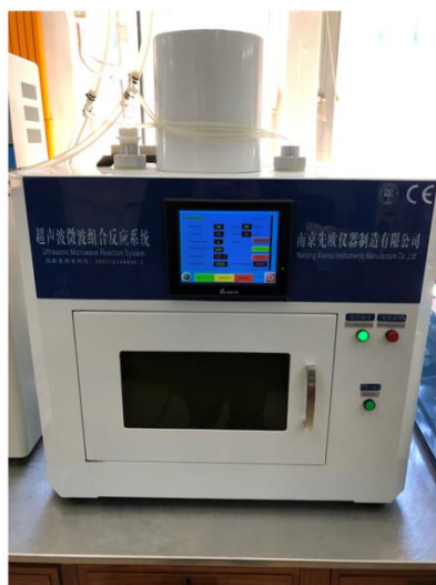
Εικόνα 31. Σύστημα αντίδρασης υπερήχων-μικροκυμάτων (Ultrasonic microwave reaction system) της εταιρίας Nanjing Xianou Instruments Manufacture Co., Ltd.
