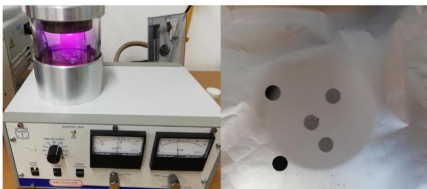
Εικόνα 50. Στα αριστερά φαίνεται η συσκευή επιχρύσωσης (SC7620 Mini Sputter Coater), ενώ στα δεξιά φαίνεται ο τρόπος με τον οποίο γίνεται η συλλογή δείγματος μέσω των δειγματοφορέων πάνω στο αλουμινόχαρτο.
