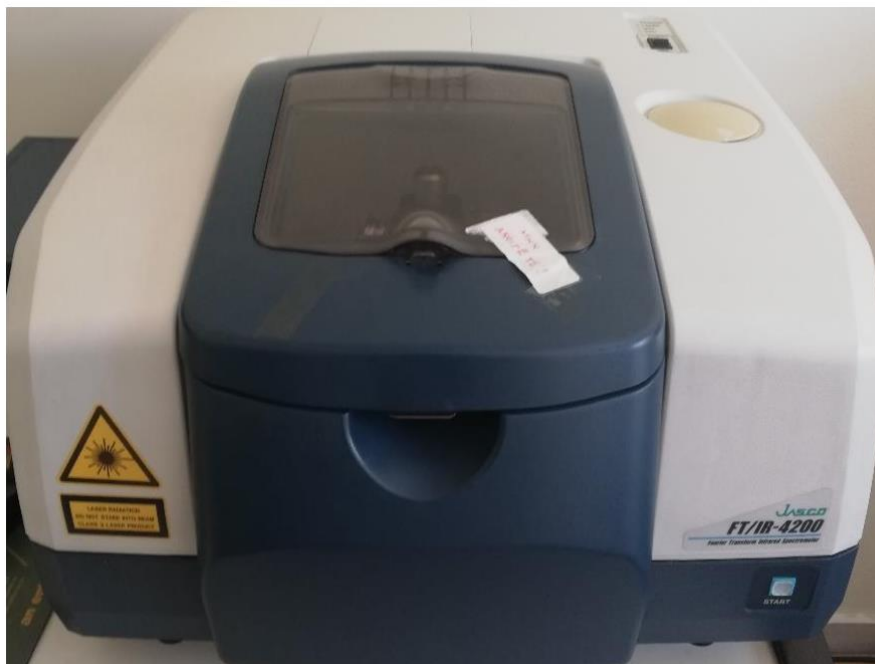
Εικόνα 47. Φασματοόμετρο υπερόθρου μετασχηματισμού Fourier (FT/IR-4200, JASCO International Co., Ltd., Tokyo, Japan) με προσαρτημένη μονάδα εξασθετισμένης ολικής ανάκλασης.
