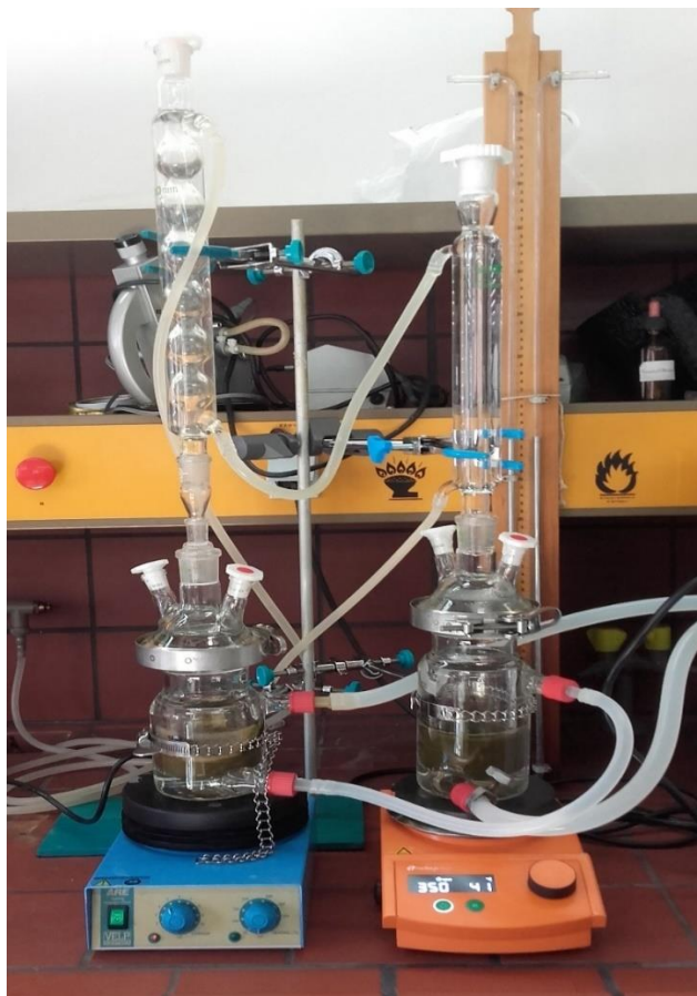
Εικόνα 2.1: Δύο διατάξεις κλασικής εκχύλισης συνδεδεμένες σε σειρά.
