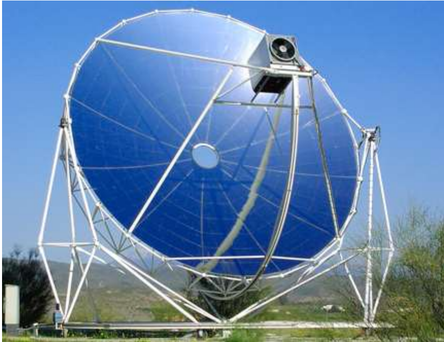
Σχήμα 2. 12: Συλλέκτης με παραβολοειδές κάτοπτρο [2.16].
