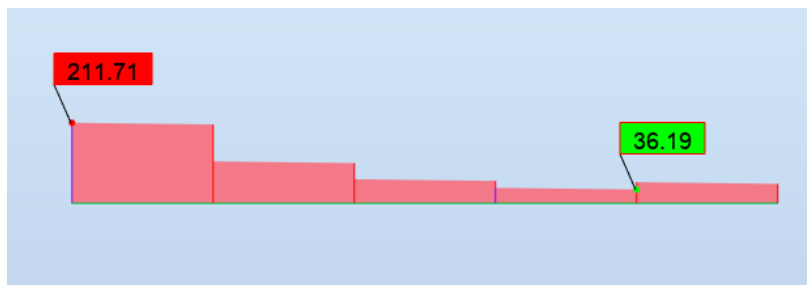
Σχήμα 3.26 Διάγραμμα τεμνουσών V_{z,Ed} δοκού 26
